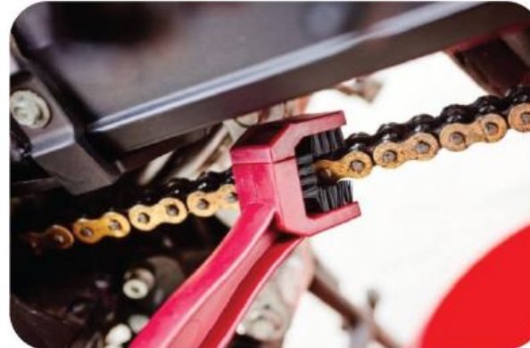
การตรวจระบบเบรกและใช้แปรงทำความสะอาดโซ่
