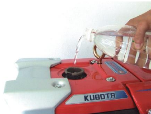
รูปที่ 14.2 การตรวจสอบและเติมน้ำระบายความร้อน
