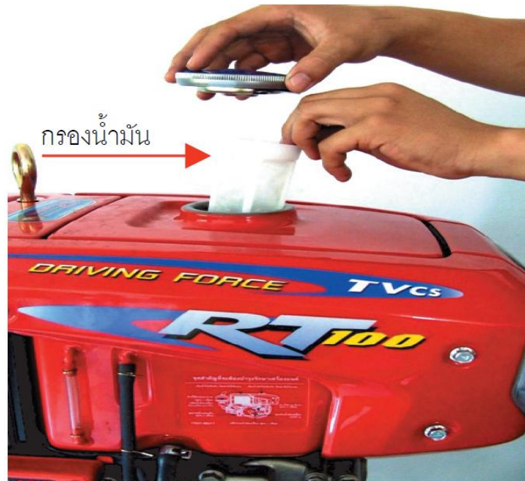
รูปที่ 14.7 การตรวจถังน้ำมันเชื้อเพลิง
