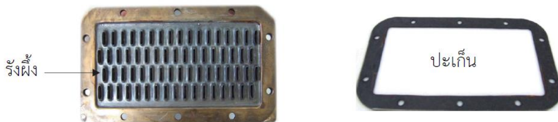
รูปที่ 13.19 การตรวจสอบสภาพหม้อน้ำ
