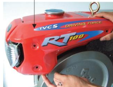
รูปที่ 13.41 การประกอบฝาครอบด้านบนของฝาครอบหม้อน้ำ ฝาครอบด้านข้างท่อไอเสียและหุยกเครื่อง
