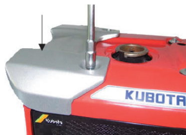
รูปที่ 13.9 การถอดฝาครอบปิดด้านบนถึงหม้อน้ำ
