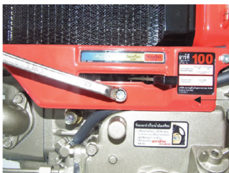
รูปที่ 13.10 การถอดฝาครอบคันเร่งด้านข้าง
