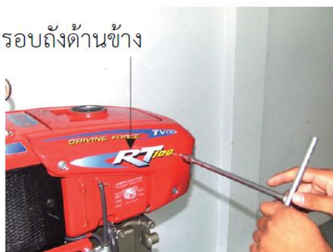
รูปที่ 13.4 การถอดชุดฝาครอบถึงด้านข้าง
