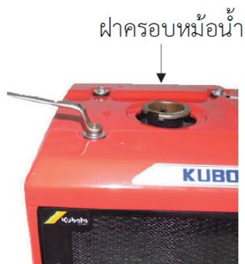
รูปที่ 13.8 การถอดฝาครอบหม้อน้ำ
