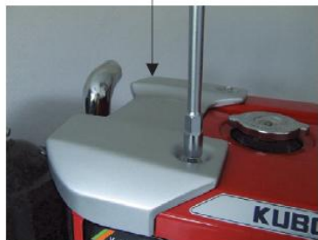
รูปที่ 13.41 การประกอบฝาครอบด้านบนของฝาครอบหม้อน้ำ ฝาครอบด้านข้างท่อไอเสียและหุยกเครื่อง
