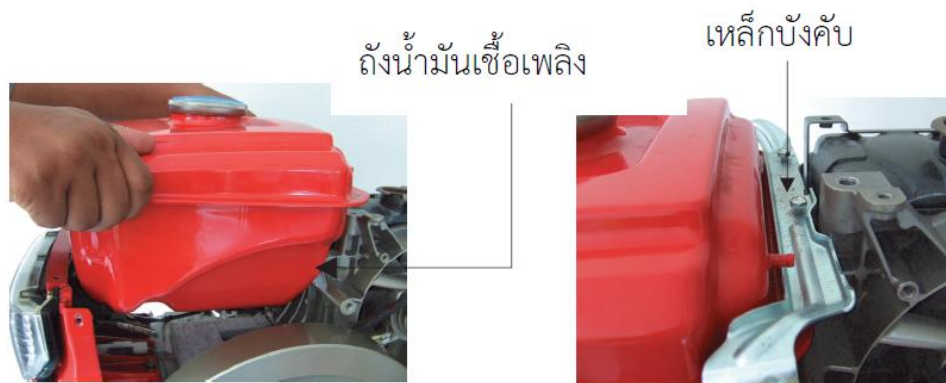
รูปที่ 13.36 การประกอบถังน้ำมันเชื้อเพลิง
