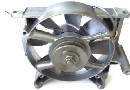
รูปที่ 13.24 การตรวจพัดลม
