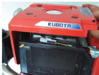
รูปที่ 13.40 การประกอบฝาครอบหม้อน้ำหรือฝากระโปรงด้านบนหม้อน้ำ
