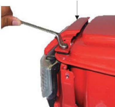
รูปที่ 13.5 การถอดฝาครอบไฟหน้า
