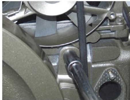
รูปที่ 13.13 การถอดสายพานพัคคัมและชุดลูกรอก
