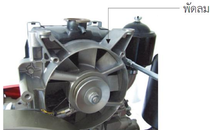
รูปที่ 13.32 การประกอบชุดพัดลมเข้ากับหม้อน้ำ
