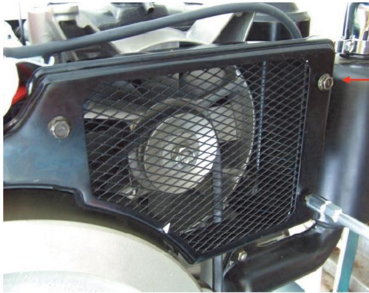
รูปที่ 13.38 การประกอบฝาครอบพัดลมและตะแกรงพัดลม
