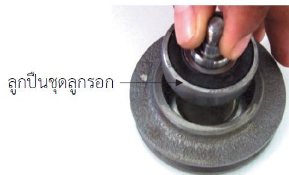
รูปที่ 13.23 การตรวจสอบลูกปืนชุดลูกกรอกตั้งสายพานพัดลม
