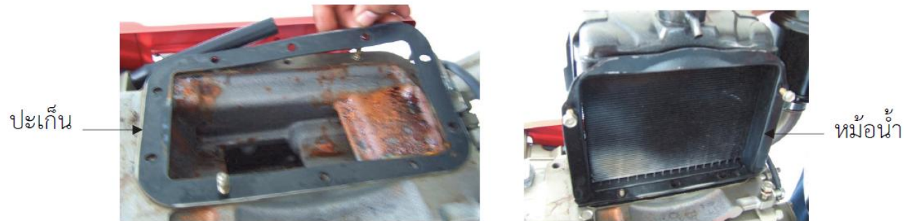
รูปที่ 13.30 การประกอบหม้อน้ำ
