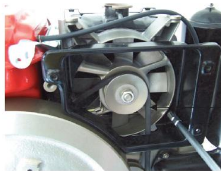
รูปที่ 13.34 การประกอบสายพานพัดลม
