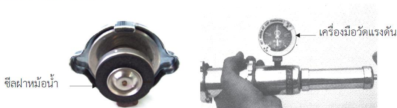
รูปที่ 13.20 การตรวจฉาหม้อน้ำ
