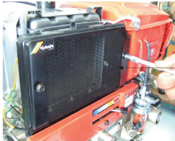
รูปที่ 13.39 การประกอบฝาครอบหม้อน้ำและตะแกรงหม้อน้ำ
