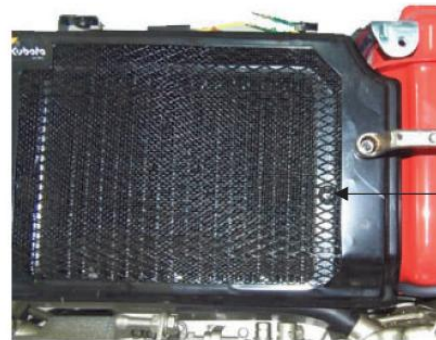
รูปที่ 13.12 การถอดตะแกรงหม้อน้ำ
