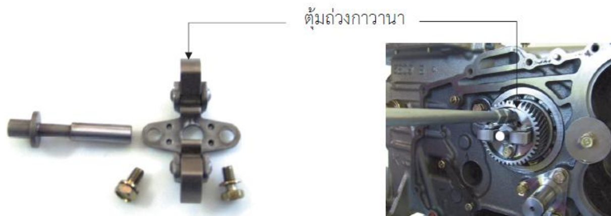
รูปที่ 12.34 การประกอบตุ้มเหวี่ยงกาวานา
