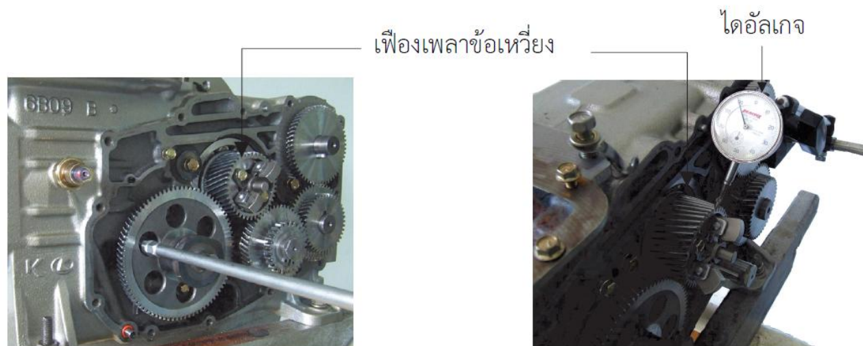
รูปที่ 12.26 การวัดช่องว่างระหว่างเฟืองเพลาลูกเบี้ยวกับเฟืองเพลาช้อเหวี่ยง
