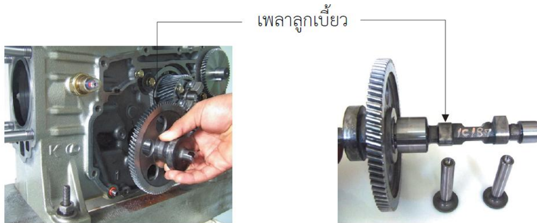
รูปที่ 12.4 การถอดเพลาลูกเบี้ยว
