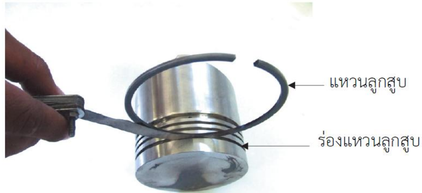
รูปที่ 12.17 การวัดช่องว่างระหว่างแหวนกับร่องแหวนของลูกสูบ
