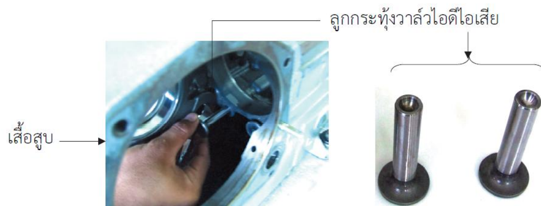
รูปที่ 12.28 การประกอบลูกกระทุ้งวาล์ว
