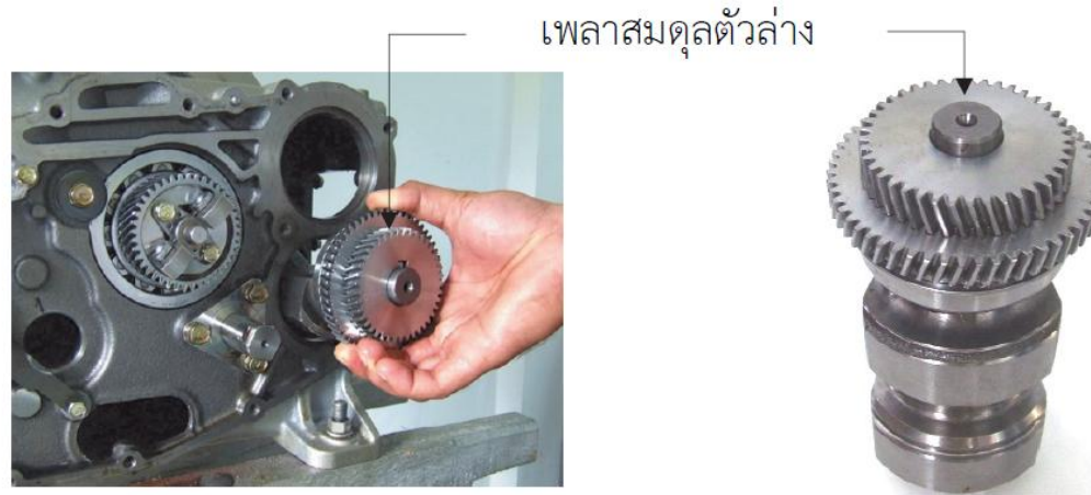
รูปที่ 12.7 การถอดเพลาสมุดูลตัวล่าง
