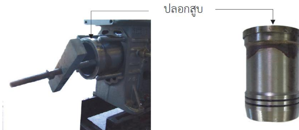
รูปที่ 12.14 การถอดปลอกสูบ
