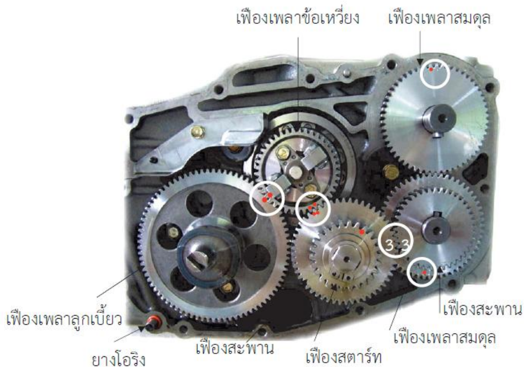
รูปที่ 12.39 การประกอบเฟืองต่าง ๆ ครบทุกตัวให้ถูกต้องตามมาร์คที่กำหนดไว้
