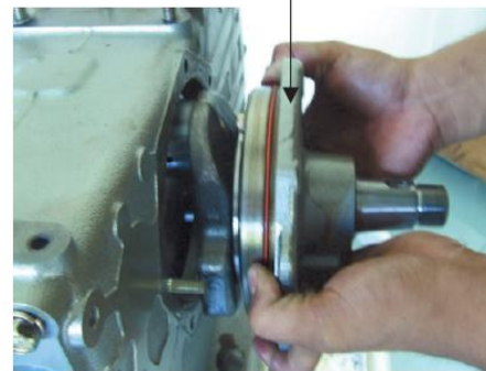
รูปที่ 12.12 การถอดเรือนลูกปืนเพลาช้อเหวี่ยงและเพลาช้อเหวี่ยง
