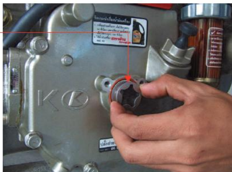
รูปที่ 11.23 การประกอบชุดปั้มน้ำมันหล่อลื่นเข้ากับฝาครอบเกียร์
