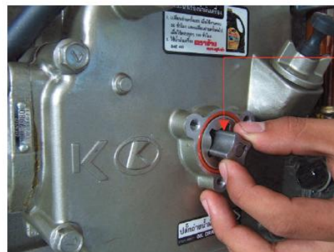
รูปที่ 11.23 การประกอบชุดปั้มน้ำมันหล่อลื่นเข้ากับฝาครอบเกียร์
