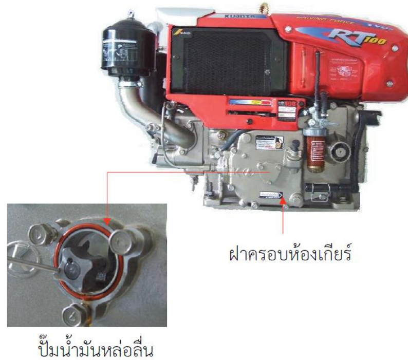
รูปที่ 11.1 ปั้มน้ำมันหล่อลื่นและฝาครอบห้องเกียร์เครื่องยนต์เล็กดีเซล
