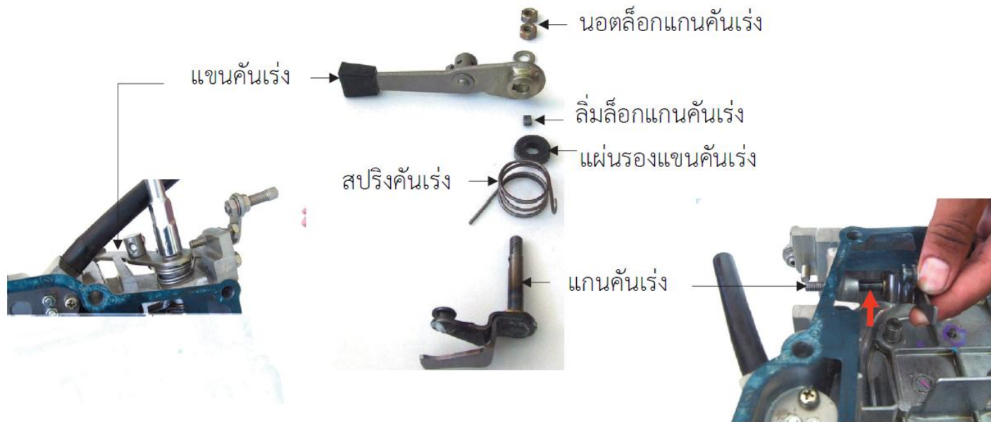
รูปที่ 11.9 การถอดคันเร่งและแกนคันเร่ง
