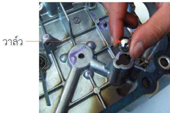
รูปที่ 11.15 การประกอบวาล์วควบคุมแรงดันน้ำมันหล่อลื่น
