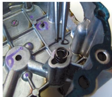
รูปที่ 11.15 การประกอบวาล์วควบคุมแรงดันน้ำมันหล่อลื่น
