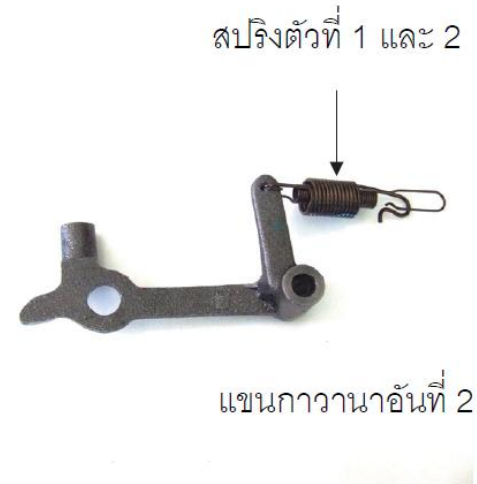
รูปที่ 11.8 การถอดแขนกาวานาอันที่ 2 และสปริงตัวที่ 1 และ 2
