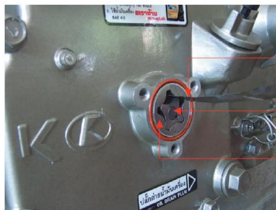
รูปที่ 11.11 การวัดช่องว่างระหว่างโรเตอร์ตัวในกับโรเตอร์ตัวนอก
