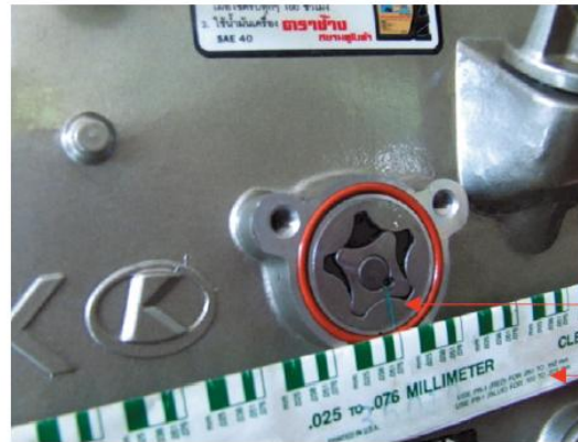
รูปที่ 11.13 การวัดช่องว่างระหว่างโรเตอร์กับฝาปิดปั้มน้ำมันหล่อลื่น
