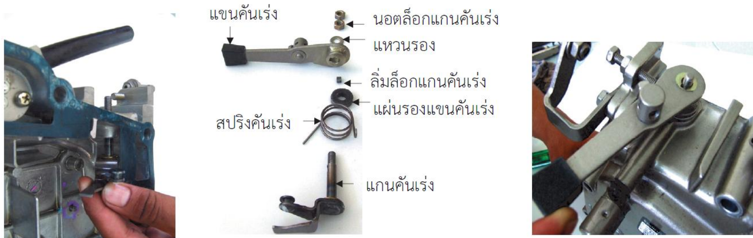
รูปที่ 11.16 การประกอบชุดคันเร่ง
