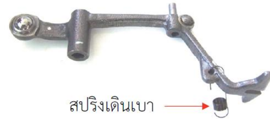
รูปที่ 11.7 การถอดแขนกาวานาอันที่ 1
