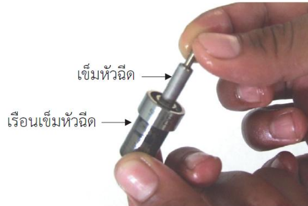
รูปที่ 10.20 การตรวจสอบการสึกหรอของหัวฉีด
