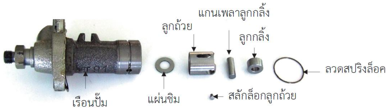
รูปที่ 10.8 ชุดลูกถ้วยปั้มน้ำมันเชื้อเพลิงส่วนล่าง
