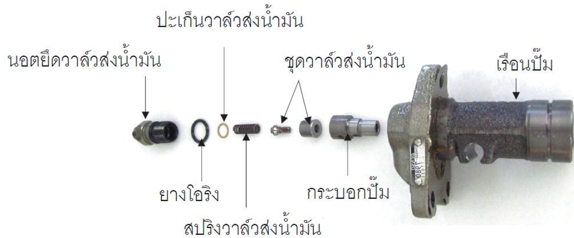
รูปที่ 10.13 ชิ้นส่วนของปั้มน้ำมันเชื้อเพลิงส่วนบน
