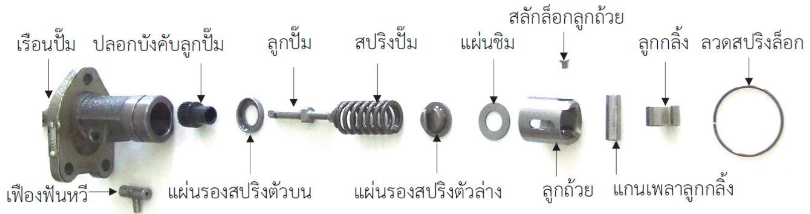
รูปที่ 10.14 ชิ้นส่วนของปั้มน้ำมันเชื้อเพลิงส่วนล่าง
