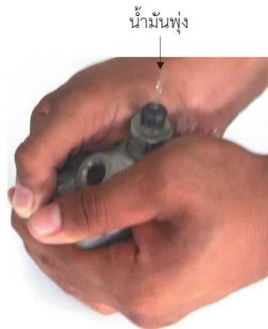
รูปที่ 10.17 การทดสอบปั้มน้ำมันเชื้อเพลิง
