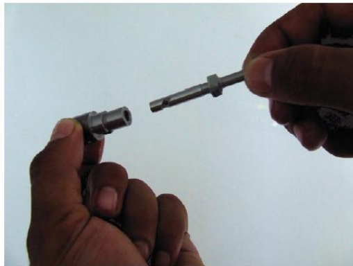
รูปที่ 10.11 การตรวจสอบการสึกหรอของกระบอกปั้มและลูกปั้ม
