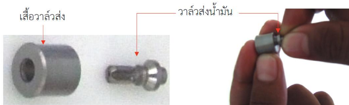
รูปที่ 10.12 การตรวจการสึกหรอของวาล์วส่งน้ำมัน
