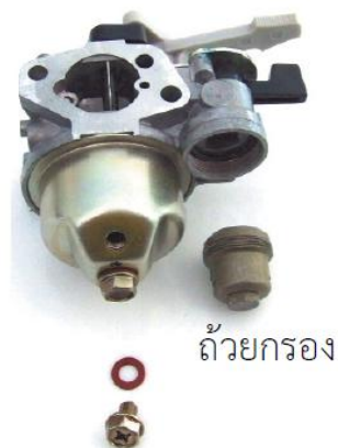
รูปที่ 7.4 การทำความสะอาดถ้วยกรองน้ำมันเชื้อเพลิง
