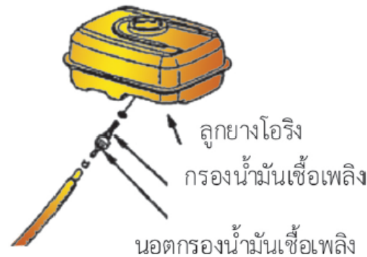
รูปที่ 7.5 การทำความสะอาดกรองน้ำมันเชื้อเพลิง
