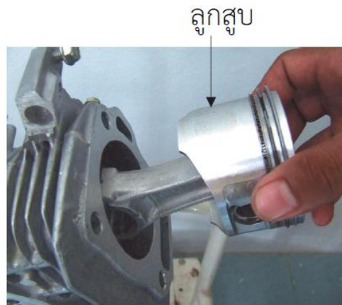
รูปที่ 6.8 แสดงการประกอบลูกสูบ
