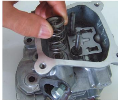
รูปที่ 6.2 แสดงการถอดฝาสูบ, ประเก็นฝาสูบและชุดวาล์วออก
