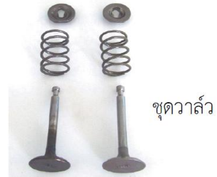
รูปที่ 6.2 แสดงการถอดฝาสูบ, ประเก็นฝาสูบและชุดวาล์วออก
