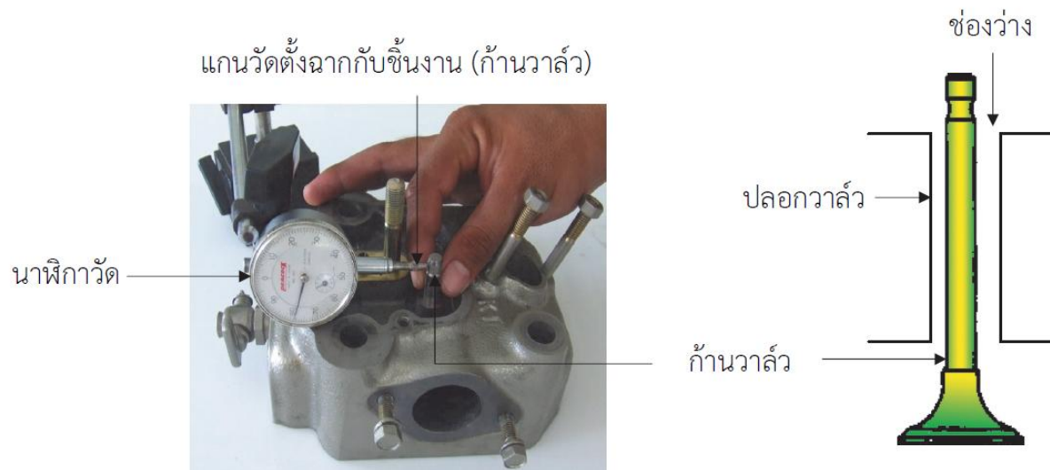
รูปที่ 5.37 การใช้นาฬิกาวัดวัดระยะรุนของก้านวาล์ว
