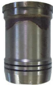
รูปที่ 1.34 ปลอกสูบแบบถอดแยกออกจากเสื้อสูบได้
