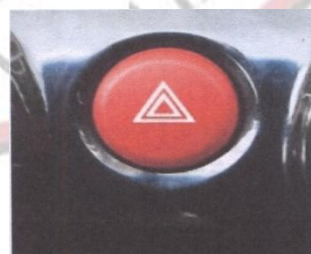
สวิตช์ไฟฉุกเฉิน
