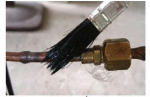
ใช้แปรงทาสีจุ่มน้ำแชมพูทาตรงรอยรั่วจะมีฟองให้เห็น
