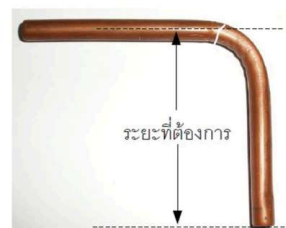
การตัดท่อแบบกำหนดระยะจากขวาไปซ้าย
