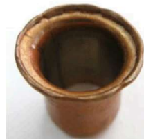
ท่อที่ไม่ได้ลบคม การลบคมท่อ
