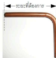
การตัดท่อแบบกำหนดระยะจากซ้ายไปขวา
