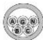
สายไฟแกนเดี่ยวในท่อร้อยสายเดียวกัน
