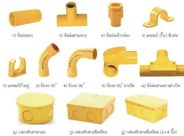
รูปที่ 1.2.81 ตัวอย่างอุปกรณ์ประกอบท่อพีวีซี
