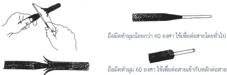
รูปที่ 1.4.2 การปกกฉนวนสายไฟฟ้าด้วยมีด
