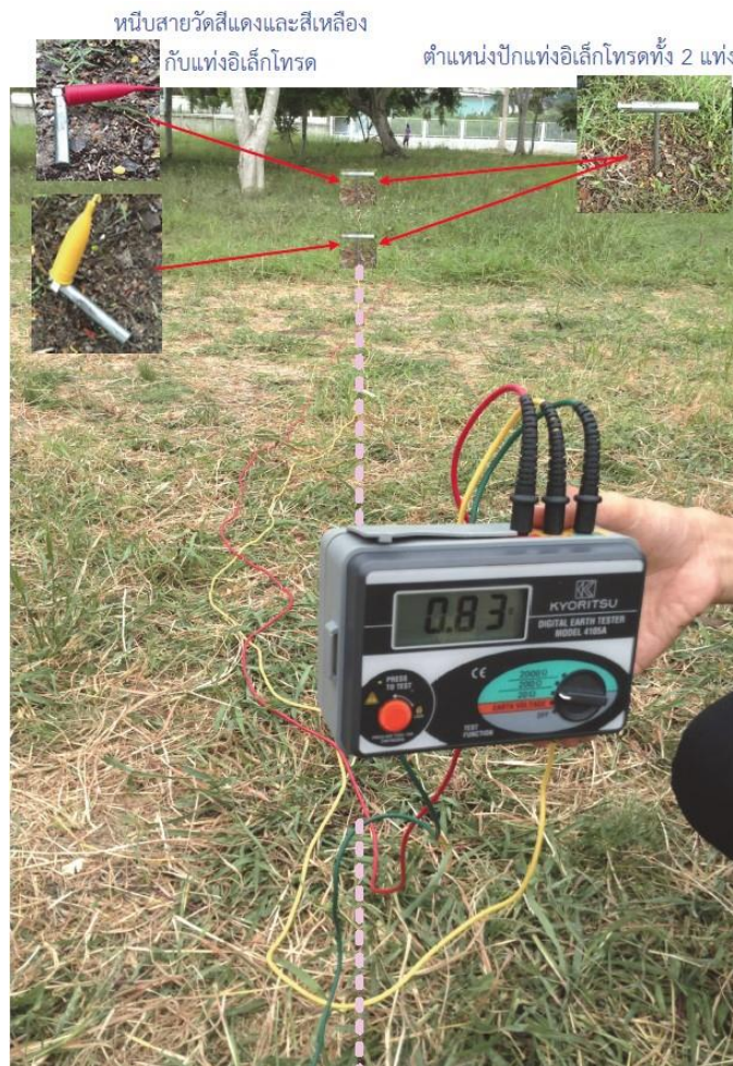
รูปที่ 4.1.36 ตัวอย่างเครื่องวัดความต้านทานการต่อลงดินและวิธีใช้งาน
