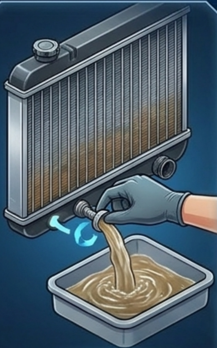
Step 1: ถ่าย (Drain) เปิดฝาหม้อน้ำและน๊อตทางปลา ถ่ายน้ำเดิมทิ้งให้หมด
