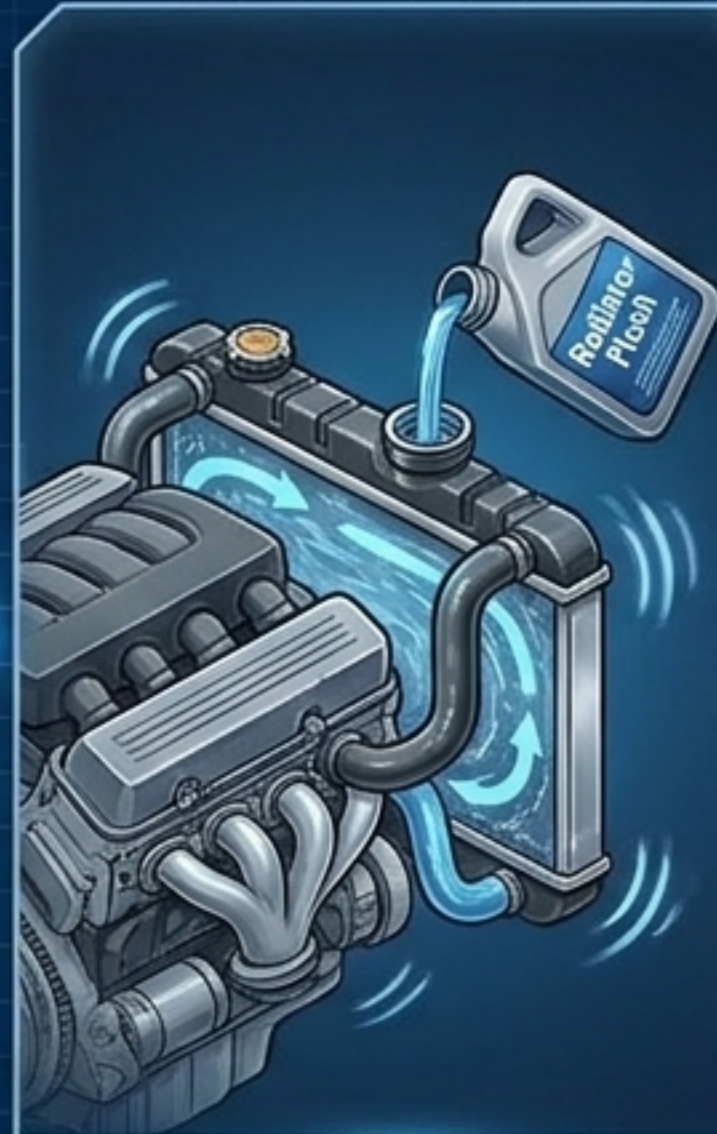
Step 2: ล้าง (Flush) เติมน้ำยาล้าง สตาร์ทเครื่อง 10-20 นาทีให้วาล์วเปิดเพื่อชะล้างตะกอน
