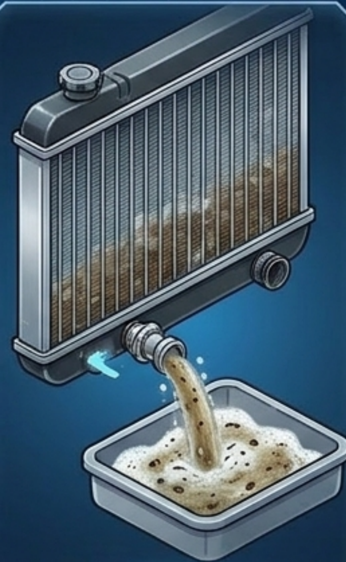
Step 3: ถ่ายซ้ำ (Drain Again) ดับเครื่อง รอให้เย็น และถ่ายน้ำยา ล้างพร้อมสิ่งสกปรกทิ้งจนหมด
