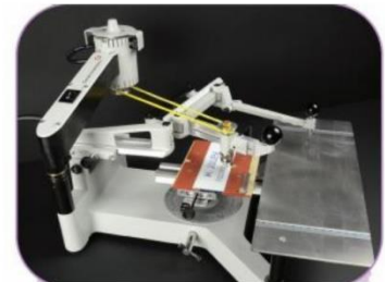
การทำงานลอกแบบของเครื่อง Pantograph Machine
