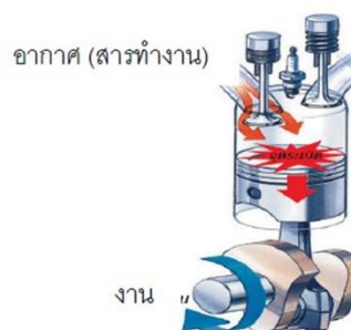
สารทำงานที่บรรจุในกระบอกสูบเพื่อเป็นตัวกลางในการทำงาน
