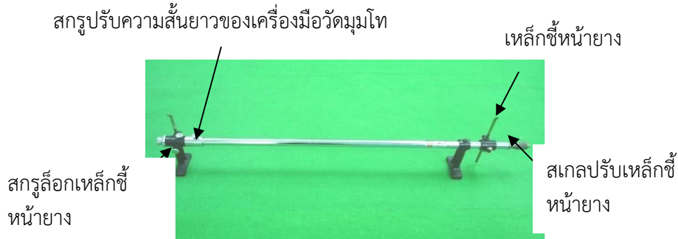
รูปที่ 5.6 แสดงลักษณะของเครื่องมือวัดมุมโท
