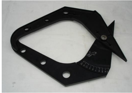
รูปที่ 4.30 แสดงลักษณะของเกจวัดความกว้างของกระทะล้อ
