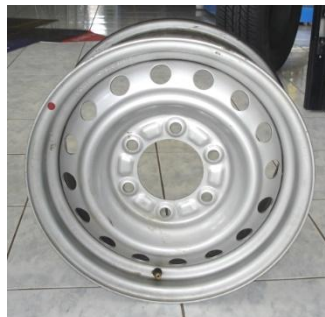
รูปที่ 4.14 แสดงลักษณะกระทะล้อแบบเหล็กแผ่นอัดขึ้นรูป
