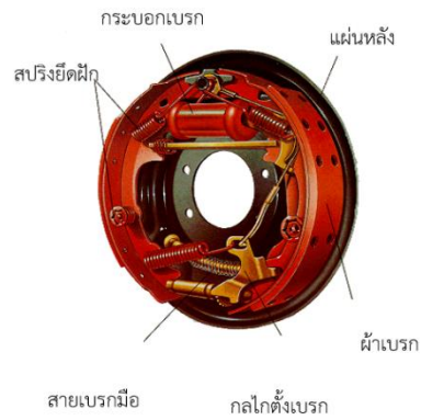
รูปที่ 3.11 แสดงลักษณะส่วนประกอบของดรัมเบรก
