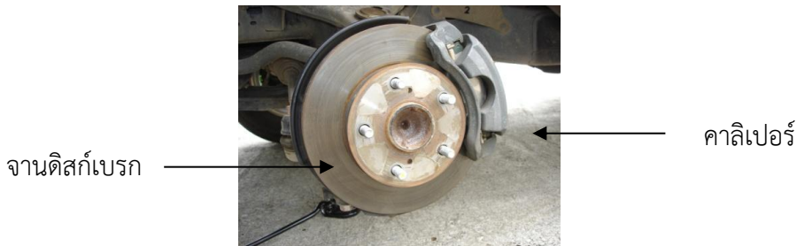
รูปที่ 3.1 แสดงลักษณะโครงสร้างของดิสก์เบรก
