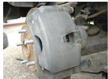
รูปที่ 3.2 แสดงลักษณะดิสก์เบรกแบบคาลิเปอร์ลอยตัว
