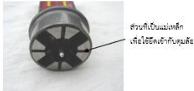
รูปที่ 5.20 แสดงลักษณะของแม่เหล็กของเครื่องมือวัตมูมล้อ
