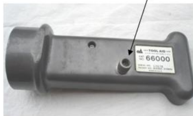
รูปที่ 5.11 แสดงลักษณะของสกรูปรับตั้งมุมคาสเตอร์
