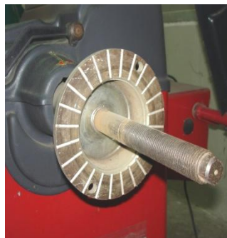
รูปที่ 4.26 แสดงลักษณะของแกนเพลลาของเครื่องสมดุลล้อ
