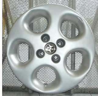
รูปที่ 4.15 แสดงลักษณะของกระทะล้อแบบโลหะหล่อผสม
