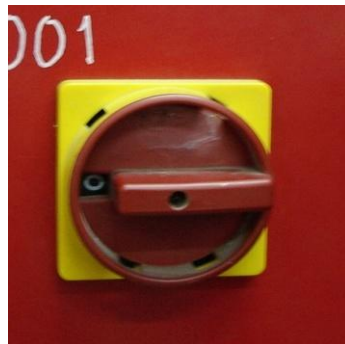
รูปที่ 4.31 แสดงลักษณะของสวิตช์ปิด-เปิดเครื่องสมดุล้อ
