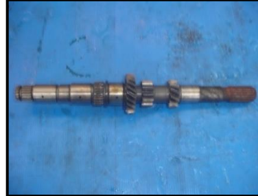
รูปที่ 2.5 แสดงลักษณะของเพลาคลัตช์ หรือเพลารับกำลัง
