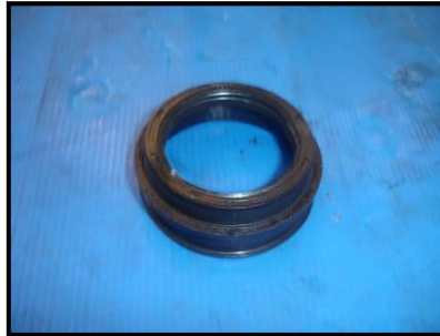
รูปที่ 5.22 แสดงลักษณะของซีลน้ำมันตัวนอก
