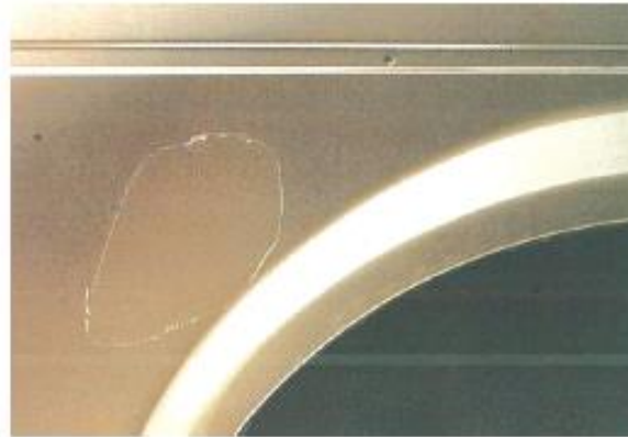
สีหลุดล่อนบนชิ้นงาน
