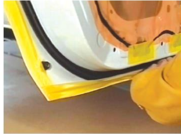
การติดขอบด้านในของประตูหลัง
