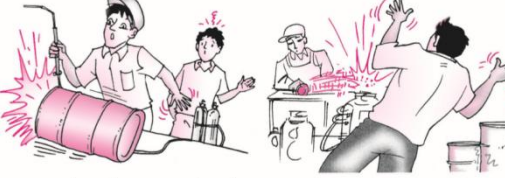
ค. อันตรายเชื่อมถังน้ำมันหรือถังเปล่าอื่น ๆ ที่ไม่มี ช่องระบายอากาศ เพราะการขยายตัวอากาศเกิด ระเบิดได้
