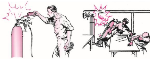
ก. อันตรายไฟไหม้ ตรวจแก๊สรั่วด้วยน้ำมัน การเปิด ก๊อกแก๊ส ควรเปิดเพียงครึ่งรอบถึง 1 รอบ
