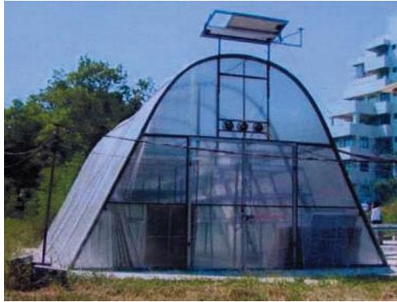
ตู้อบแห้งโดยใช้พลังงานเฉพาะจากดวงอาทิตย์
