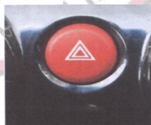
สวิตช์ไฟฉุกเฉิน
