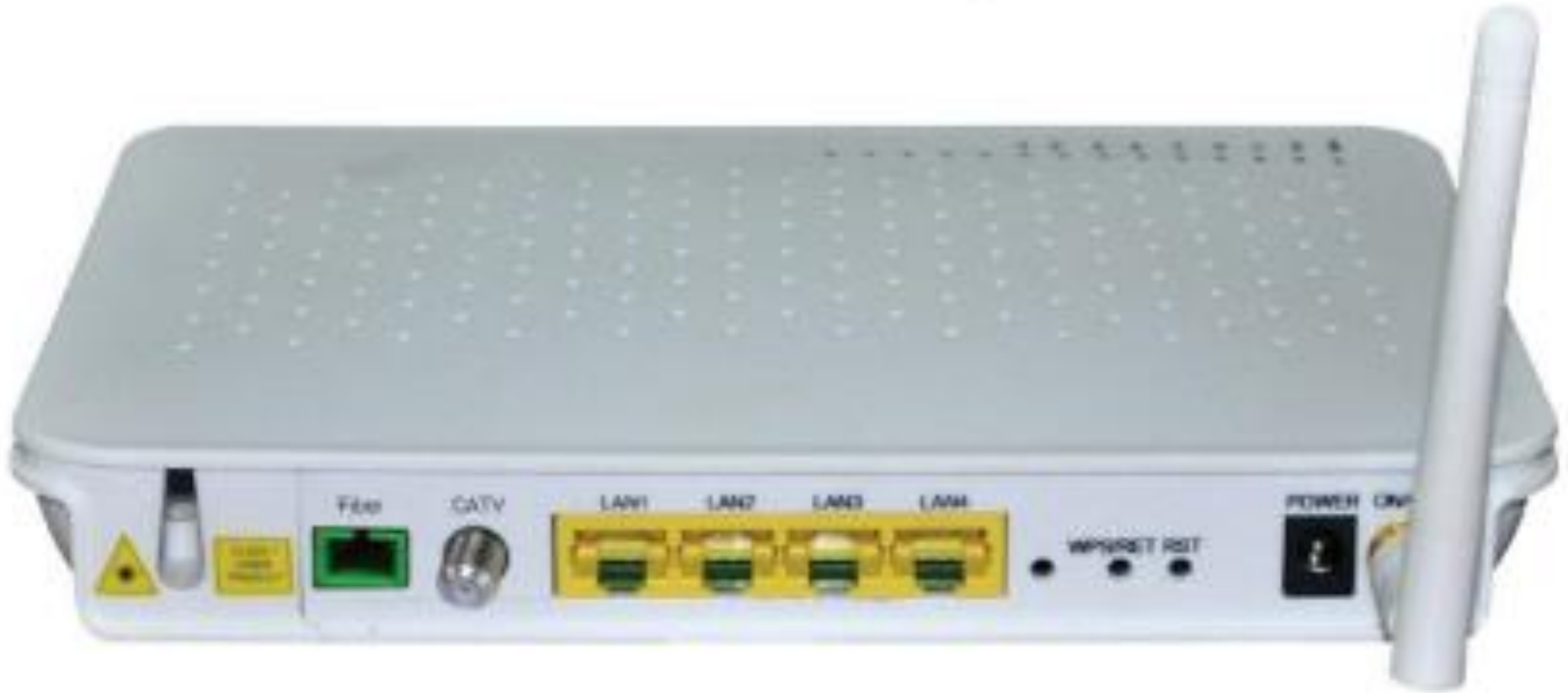
รูปที่ 4.6 Optical Network Unit
