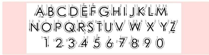
การเขียนตัวอักษรภาษาอังกฤษตัวพิมพ์ใหญ่และตัวเลขอารบิกแบบตัวตรง (แบบ V)
