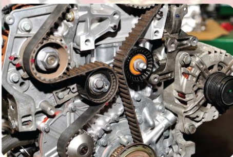
รูป การส่งกำลังด้วยสายพานฟัน (สายพานไทมิง)
