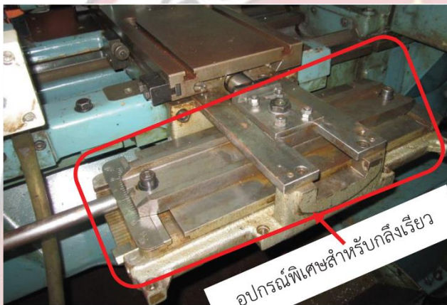
รูป อุปกรณ์พิเศษสำหรับกลึงเรียว (Taper Attachment)
