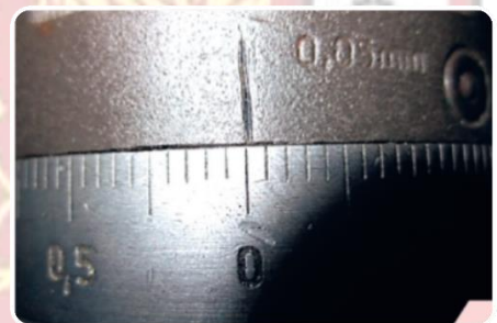
ตั้งสเกลที่แขนหมุนป้อนที่ แทนเลื่อนตัดขวางเป็น 0 (ศูนย์)
