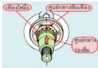
รูปที่ 21 แสดงตำแหน่งของฟันเฟืองกับร่องทิม
