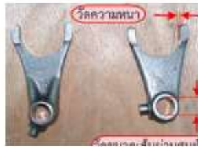
รูปที่ 22 แสดงตำแหน่งการวัดก้านสูบเปลี่ยนเกียร์
