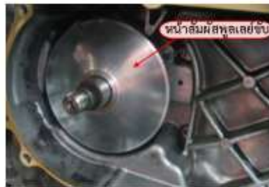
รูปที่ 14 แสดงการประกอบชุดตุ้มน้ำหนัก
