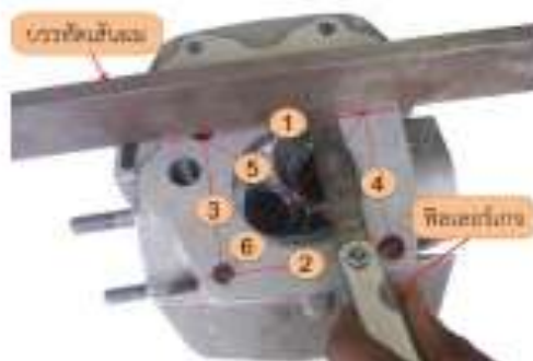
รูปที่ 15 แสดงวิธีการวัดความโก่งตัวของฝาสูบ
