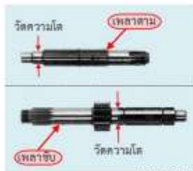
รูปที่ 26 แสดงตำแหน่งการวัดความโตเพลลา
