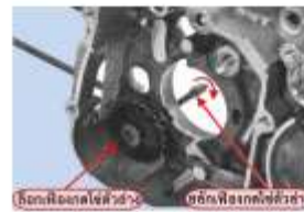
รูปที่ 38 แสดงการประกอบสลักเฟืองทดโซ่
