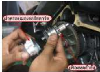
รูปที่ 19 แสดงการประกอบเฟืองทดกำลังและฝาครอบ
