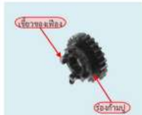
รูปที่ 24 แสดงร่องก้ามปูและเขี้ยวของเฟือง
