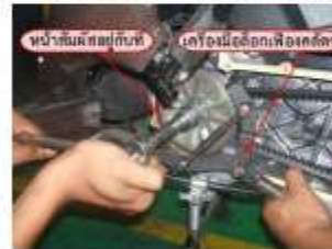
รูปที่ 5 แสดงการถอดน็อตยึดชุดเลย์ซ์
