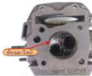
รูปที่ 14 แสดงลักษณะของห้องเผาไหม้
