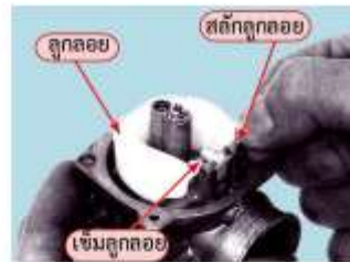
รูปที่ 8 แสดงการถอดลูกลอยและเข็มลูกลอย
