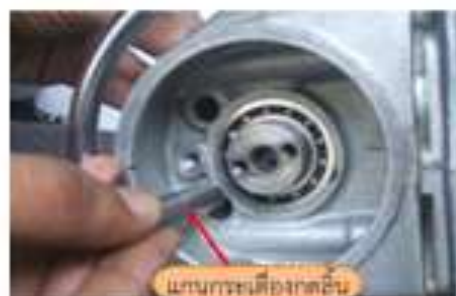
รูปที่ 11 แสดงการถอดกระตือรือร้นและแกนกระตือรือร้น
