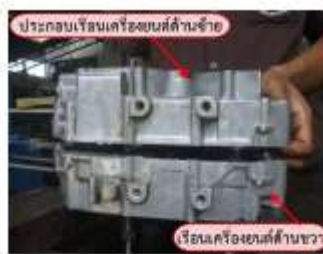
รูปที่ 40 แสดงการประกอบเรือนเครื่องยนต์
