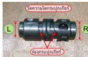
รูปที่ 23 แสดงตำแหน่งการวัดก้านสูบเปลี่ยนเกียร์
