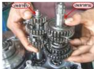
รูปที่ 35 แสดงการประกอบชุดเฟืองเข้ากับเรือนเครื่องยนต์
