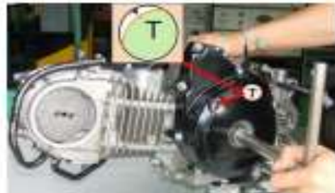
รูปที่ 4 แสดงตำแหน่งบนล้อแม่เหล็กและฝาครอบ
