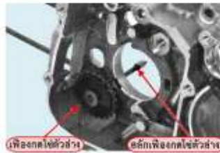
รูปที่ 15 แสดงการถอดเฟืองทดโซ่ตัวล่าง
