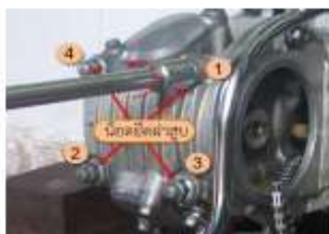
รูปที่ 8 แสดงการถอดน็อตยึดฝาสูบ
