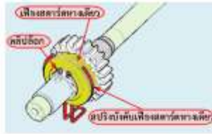
รูปที่ 13 แสดงการถอดคลีปล็อกเฟืองสแตร์ตทางเดียวและสปริง
