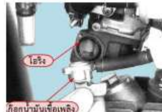
รูปที่ 12 แสดงการตรวจสอบสภาพซีลโอริง
