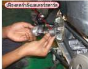
รูปที่ 4 แสดงการถอดเฟืองทดกำลัง
