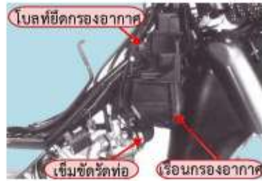
รูปที่ 2 แสดงการถอดเรือนกรองอากาศ
