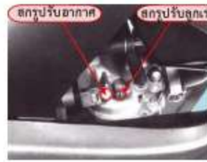
รูปที่ 19 แสดงการปรับส่วนผสมและความเร็วรอบเดินเบา
