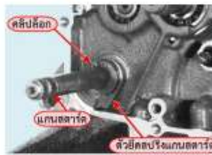
รูปที่ 10 แสดงการถอดคลิปล็อกและตัวยึดสปริง
