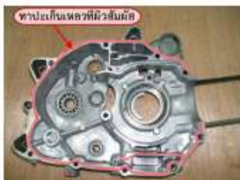
รูปที่ 39 แสดงตำแหน่งการทาปะเก็นเหลว
