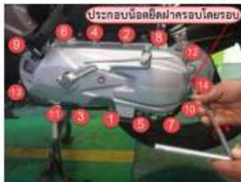
รูปที่ 21 แสดงตำแหน่งขันโบลท์ยึดโดยรอบ
