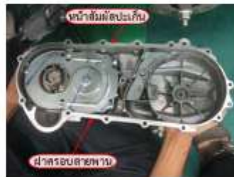
รูปที่ 20 แสดงการประกอบฝาครอบสายพาน
