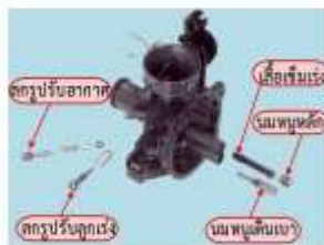
รูปที่ 9 แสดงการถอดนมหนูหลักและนมหนูเดินเบา
