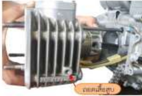
รูปที่ 25 แสดงการถอดเสื้อสูบ
