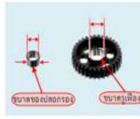
รูปที่ 25 แสดงตำแหน่งการวัดบูชและเฟือง
