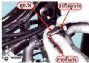
รูปที่ 3 แสดงการถอดสายคันเร่ง
