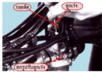
รูปที่ 18 แสดงการประกอบลูกสูบ
