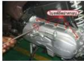
รูปที่ 2 แสดงการถอดโบลท์ยึดฝาครอบ
