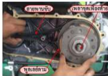
รูปที่ 16 แสดงการประกอบพูลเลย์ตามและสายพาน
