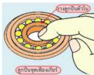
รูปที่ 27 แสดงการตรวจสอบสภาพลูกปืน
