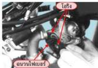
รูปที่ 16 แสดงการประกอบซีลโอริงท่อไอเสียรูปที่ 17 แสดงการประกอบเรือนคาร์บูเรเตอร์
