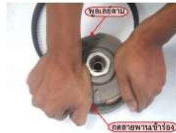
รูปที่ 15 แสดงการประกอบสายพานเข้ากับพูลเลย์ตาม
