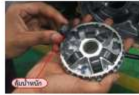
รูปที่ 13 แสดงลักษณะการปรับเรียงตุ้มน้ำหนัก
