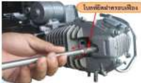
รูปที่ 3 แสดงการถอดน็อตยึดฝาครอบเครื่องยนต์ด้านซ้าย
