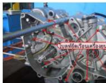
รูปที่ 3 แสดงการถอดโบลท์ยึดเรือนเครื่องยนต์
