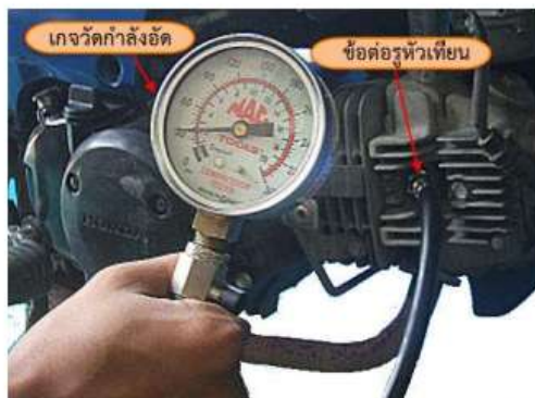
รูปที่ 2 การตรวจวัดกำลังอัดของเครื่องยนต์
