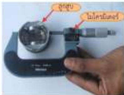
รูปที่ 31 แสดงการวัดความโตของลูกสูบ
