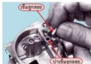
รูปที่ 11 แสดงการตรวจสอบเข็มลูกลอยและบำเข็ม
