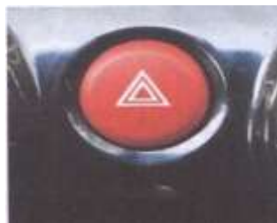
สวิตช์ไฟฉุกเฉิน
