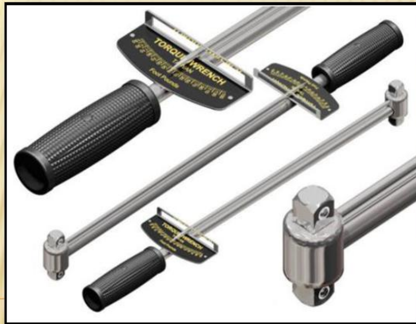
รูปที่ 1.8 ลักษณะของประแจวัดแรงบิดแบบเข็มชี้
