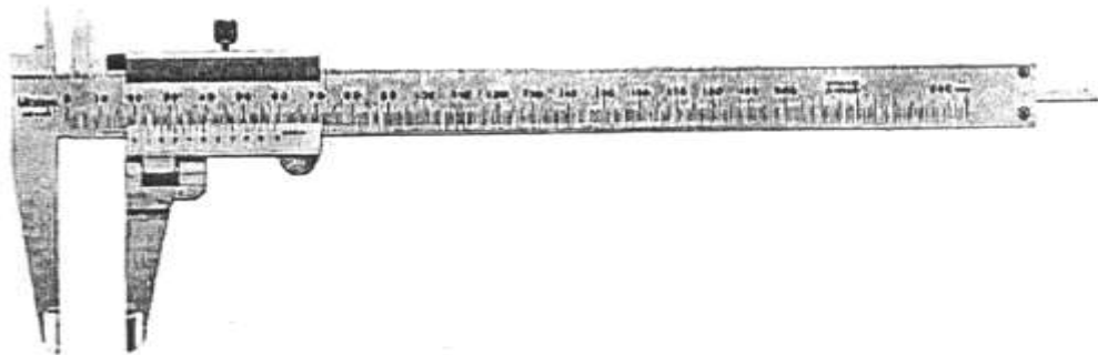
รูปที่ 2.45 เวอร์เนียแบบปากวัดโยกปรับได้ความละเอียด (0.05 มม.)
