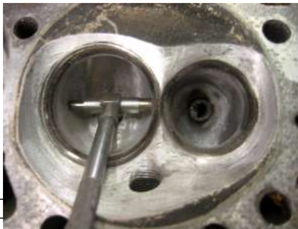
รูปที่ 5.72 การวัดขนาดรูชิ้นงานและลือคสกรูแกนวัด
