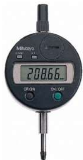
รูปที่ 4.14 นาฬิกาวัดแสดงค่าบนจอวัด L.C.D เปลี่ยนการวัดเป็นระบบเมตริกและระบบอังกฤษในตัวเดียวกัน
