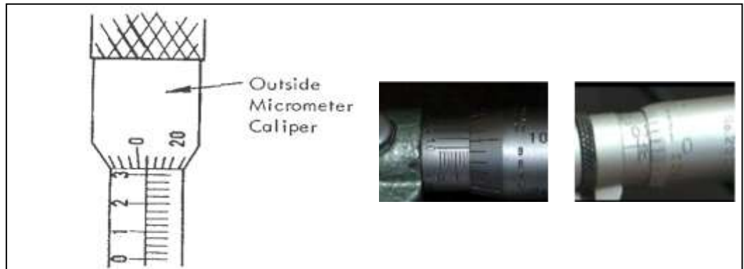
รูปที่ 3.99 แสดงสเกลของไมโครมิเตอร์วัดลิกจะเริ่มที่ขนาดใหญ่ที่สุด
