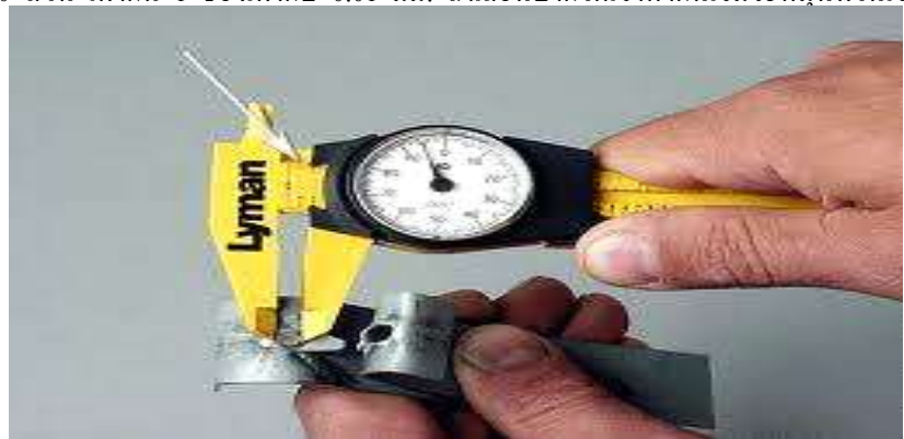
รูปที่ 2.64 เวอร์เนีย บอกรายละเอียดหน้าปัด ค่าความละเอียด 0.02 มม.
