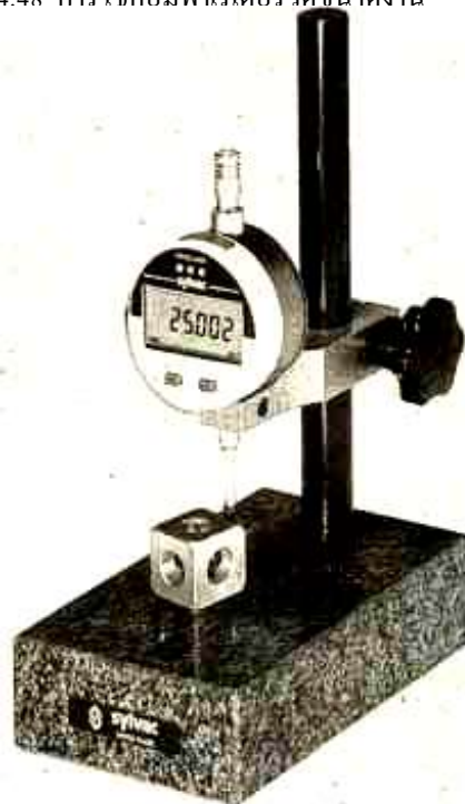
รูปที่ 4.48 การใช้คอมพารเตอร์วัดขนาดงาน
