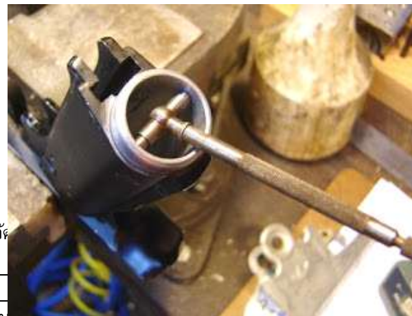
รูปที่ 5.72 การวัดขนาดรูชิ้นงานและลือคสกรูแกนวัด
