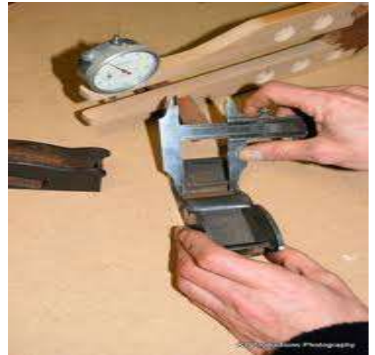
รูปที่ 2.59 เวอร์เนียร์วัดหาระยะห่างรูปแบบดิจิทัล และการวัดรู
