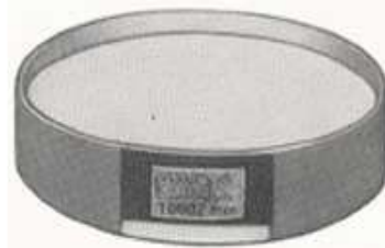
รูปที่ 3.34 แผ่นแก้วตรวจสอบความราบเรียบของหน้าสัมผัสของแกนวัดไมโครมิเตอร์
