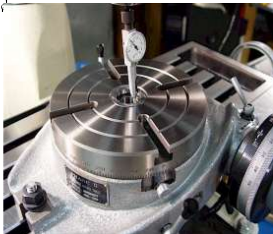
รูปที่ 4.27 การเช็คศูนย์ชิ้นงานทรงกระบอก
