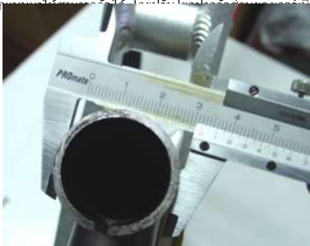
รูปที่ 2.46 การใช้ปากวัดปรับเลื่อนให้สามารถวัดงานที่สูงต่ำไม่เท่ากัน
