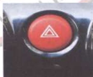
สวิตช์ไฟฉุกเฉิน
