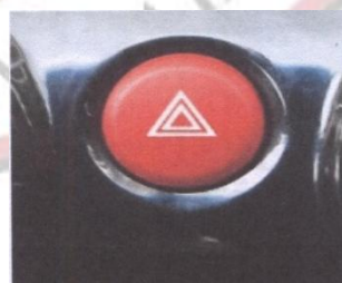
สวิตช์ไฟฉุกเฉิน
