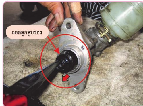
รูปที่ 4.49 ถอดลูกสูบรองหรือลูกสูบชุดที่ 2
