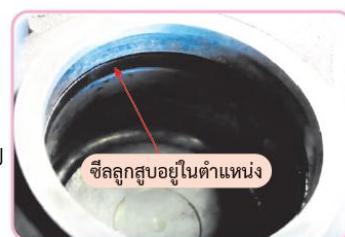
รูปที่ 4.94 ประกอบซีแลมป์ลูกสูบ
