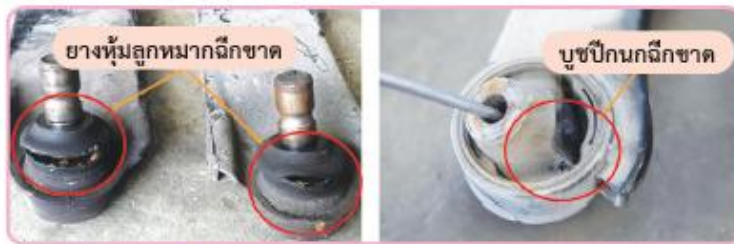
รูปที่ 12.13 ตรวจสอบลูกหมากและบุชปีกนก
