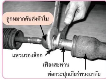
รูปที่ 7.15 ถอดลูกหมากคันส่งตัวใน
