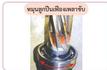
รูปที่ 7.24 ตรวจสอบการสึกหรอลูกปืนเฟืองขับ
