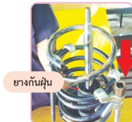
รูปที่ 8.19 ประกอบสปริงชุดเข้ากับบารอง
