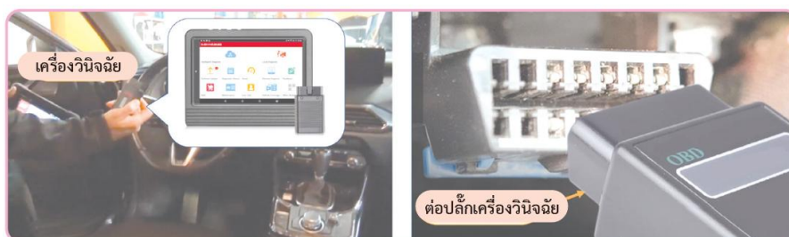
รูปที่ 16.7 การเชื่อมต่อเครื่องมือวินิจฉัย
