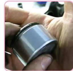
รูปที่ 4.93 ลูกสูบที่ทำความสะอาดแล้ว และสามารถนำไปใช้งานได้
