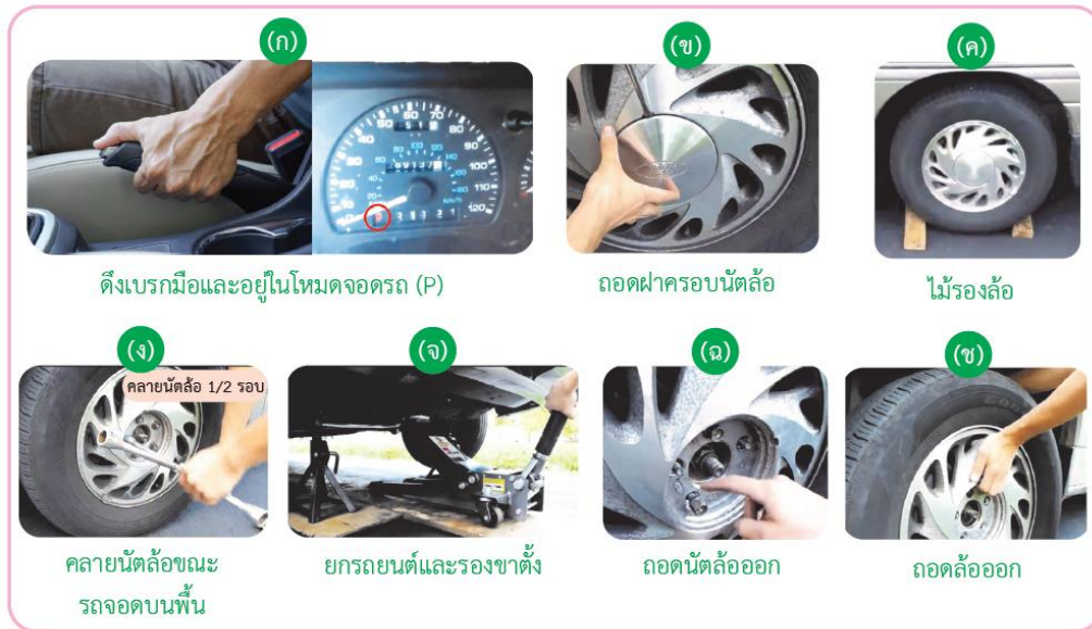
รูปที่ 3.28 ขั้นตอนการถอดล้อรถยนต์
