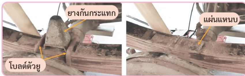
รูปที่ 11.12 ถอดอย่างกันกระแทก
