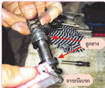
รูปที่ 4.50 ทาจาระบีที่ลูกยาง
