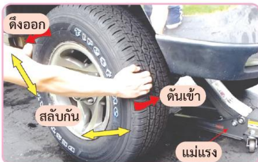
รูปที่ 7.5 ตรวจสอบความหลวมลูกหมาก
