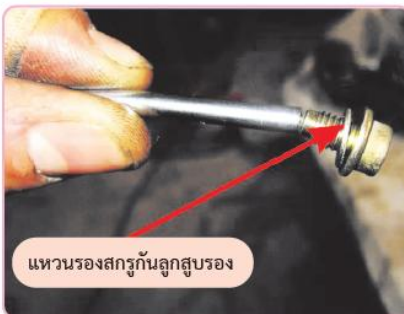
รูปที่ 4.52 แหวนรองสกรูกับลูกสูบรอง
