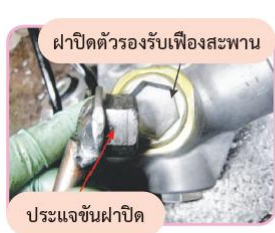
รูปที่ 7.17 คลายนัตล็อก ฝาปิดตัวรองรับเฟืองสะพาน
