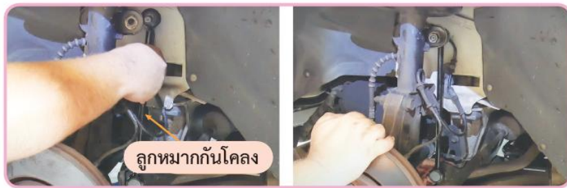
รูปที่ 13.14 ประกอบลูกหมากกันโคลง
