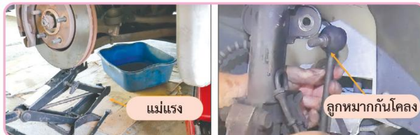
รูปที่ 13.12 ถอดลูกหมากกันโคลง
