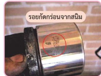
รูปที่ 4.90 รอยกัดกร่อนจากสนิม
