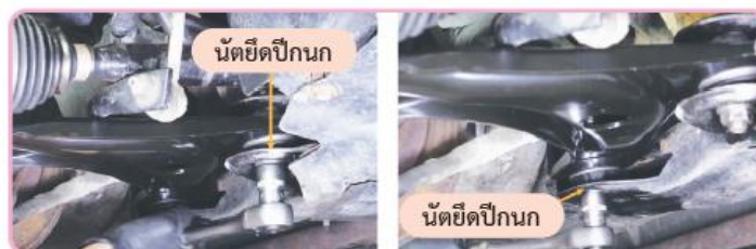
รูปที่ 12.15 ยึดปีกนกเข้ากับตัวรถ
