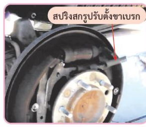
รูปที่ 4.106 ถอดสปริงสกรูปรับตั้งเบรคออก
