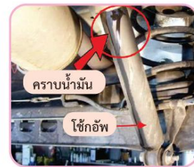
รูปที่ 9.14 ตรวจสอบน้ำมันที่ซึมออกจากโช้กอัพ
