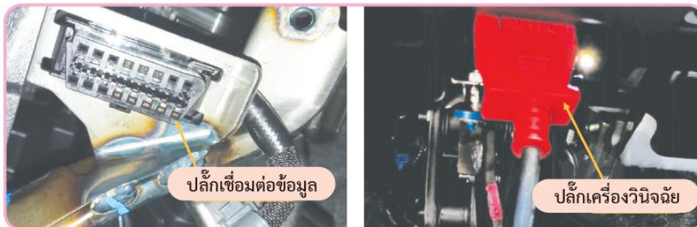
รูปที่ 15.7 เสียบปลั๊กเครื่องมือ OBD-II เข้ากับพอร์ต OBD-II ของรถยนต์
