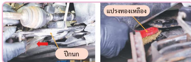
รูปที่ 12.11 ถอดปีกนกทำความสะอาด
