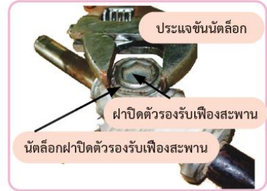
รูปที่ 7.16 คลายนัตล็อก ฝาปิดตัวรองรับเฟืองสะพาน
