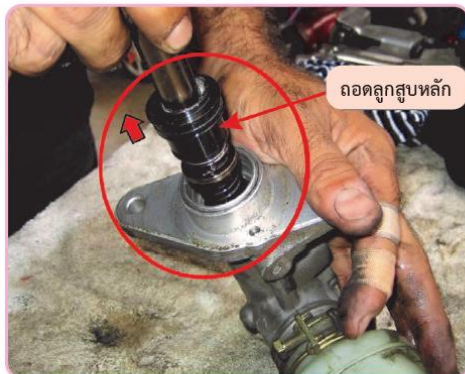
รูปที่ 4.48 ถอดลูกสูบหลักหรือลูกสูบชุดที่ 1
