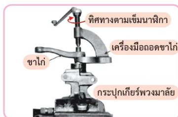
รูปที่ 6.17 ตัดตั้งเครื่องมือพิเศษและถอดขาไก่ออก
