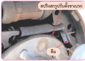
รูปที่ 4.105 ใช้คีมถอดสปริงสกรูปรับตั้งขาเบรค
