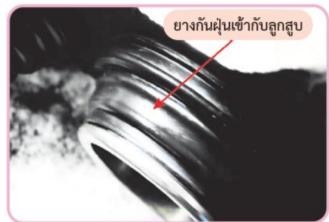
รูปที่ 4.98 ประกอบยางกันฝุ่นเข้ากับลูกสูบ
