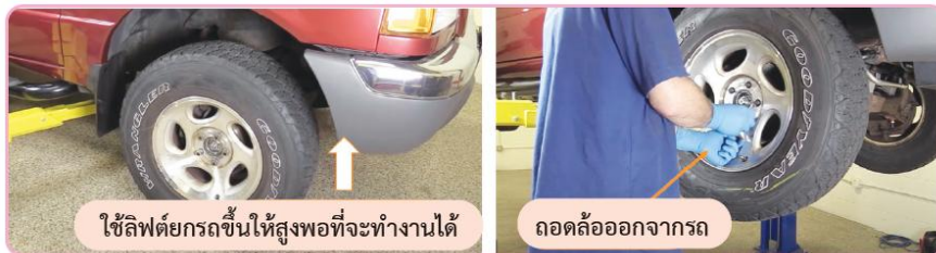
รูปที่ 10.6 ยกรถขึ้นและถอดล้อออก
