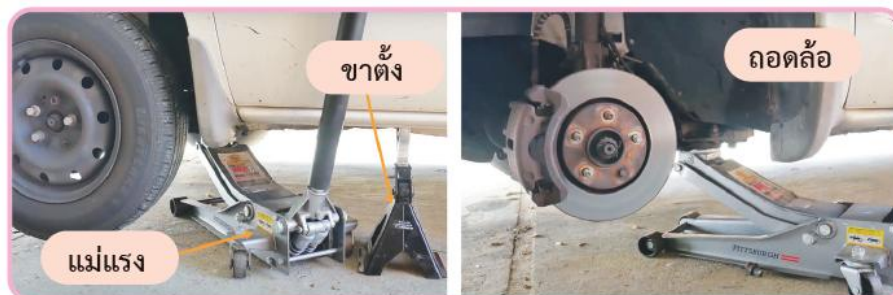
รูปที่ 13.9 ขึ้นแม่แรงรองขาตั้งและถอดล้อออก
