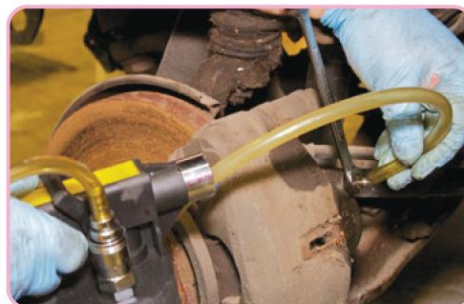
รูปที่ 4.60 ต่อเครื่องไล่ลมสุญญากาศเข้ากับสกรูไล่ลม
