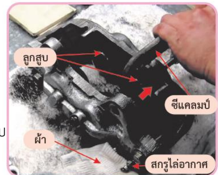
รูปที่ 4.80 ใช้ซีแคลมป์บีบลูกสูบ
