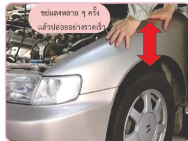
รูปที่ 8.9 ขยับรถขึ้นลงเพื่อตรวจสอบสภาพ การทำงานของโซ้กอ๊พ
