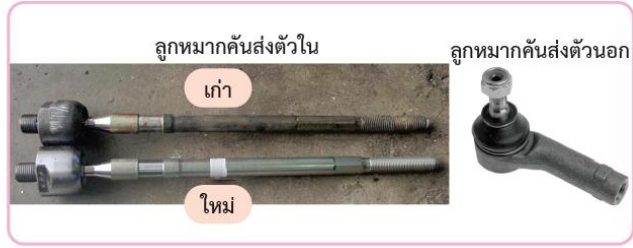
รูปที่ 7.27 เปรียบเทียบลูกหมากคันส่งของเก่ากับใหม่
