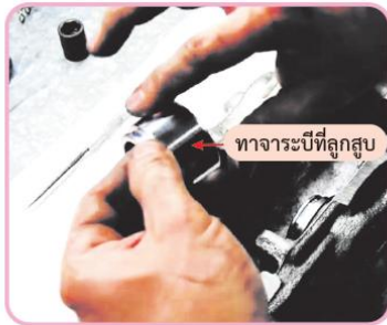
รูปที่ 4.95 ทาจาระบีที่ผิวสัมผัสของลูกสูบ
