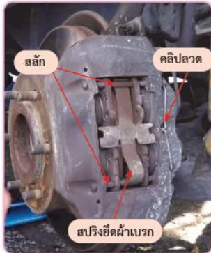
รูปที่ 4.64 ตำแหน่งสลักคลิปสวด และสปริงยึดผ้าเบรก
