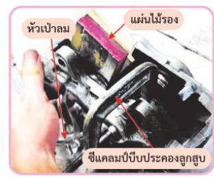
รูปที่ 4.86 ถอดลูกสูบที่เหลือ
