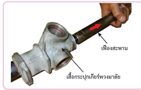
รูปที่ 7.22 ถอดเฟืองสะพาน
