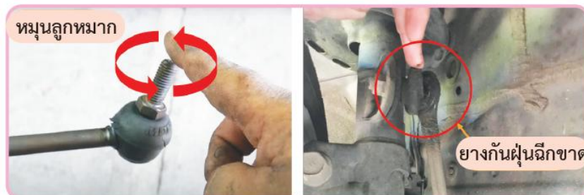
รูปที่ 13.13 ตรวจสอบลูกหมากกันโคลง
