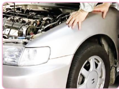
รูปที่ 8.8 วางมือเหนือแมคเฟอร์สันสตรัท
