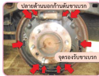
รูปที่ 4.119 ตำแหน่งทาจาระบิบนแผ่นรองหลัง
