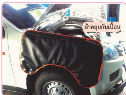
รูปที่ 4.42 คลุมผ้ากันเปื้อนด้านข้างรถยนต์
