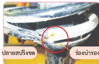
รูปที่ 8.20 จัดปลายสปริงชุดให้ลงตำแหน่ง
