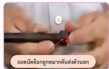
รูปที่ 7.12 ถอดนัตล้อลูกหมาก
