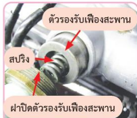
รูปที่ 7.18 ถอดสปริงและ ตัวรองรับเฟืองสะพาน
