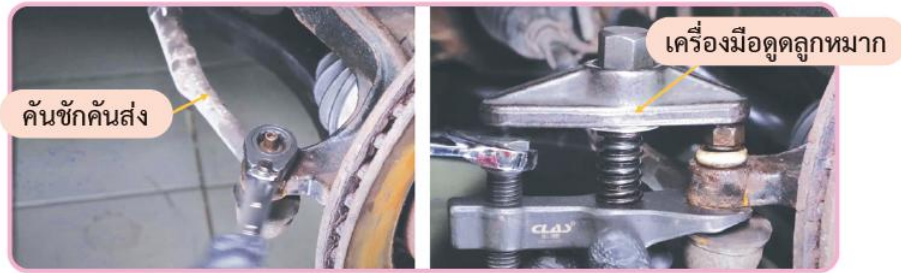
รูปที่ 12.8 ถอดลูกหมากค้ำคั่นค้อน
