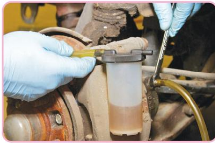
รูปที่ 4.56 ต่อท่ออย่างเข้ากับสกรูไล่ลม และคลายสกรูไล่ลม
