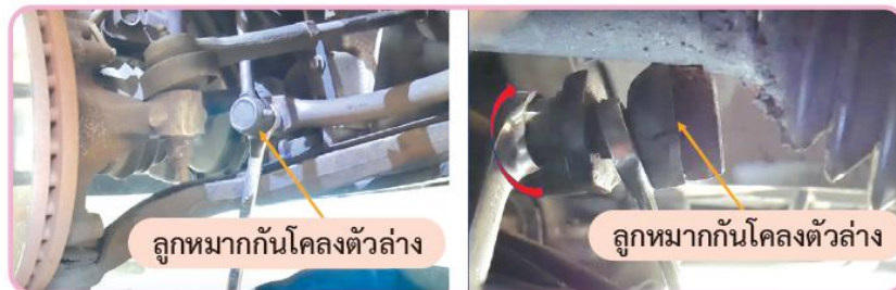
รูปที่ 13.11 ถอดลูกหมากกันโคลงตัวล่าง
