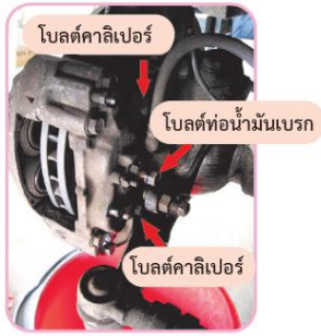
รูปที่ 4.77 ถอดท่อน้ำมันเบรก และถอดโบลต์คาลิเปอร์
