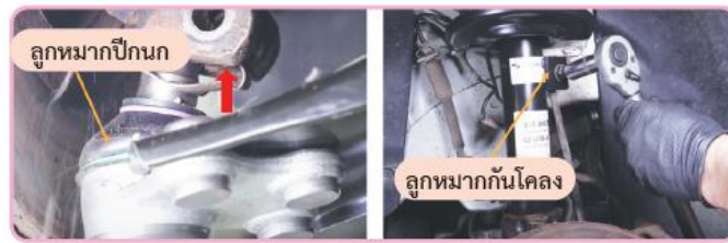
รูปที่ 12.16 ประกอบลูกหมากปีกนกและลูกหมากกันโคลง
