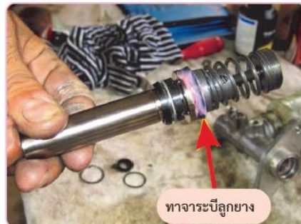
รูปที่ 4.53 ทาจาระบีที่ลูกยางลูกสูบชุดที่ 1
