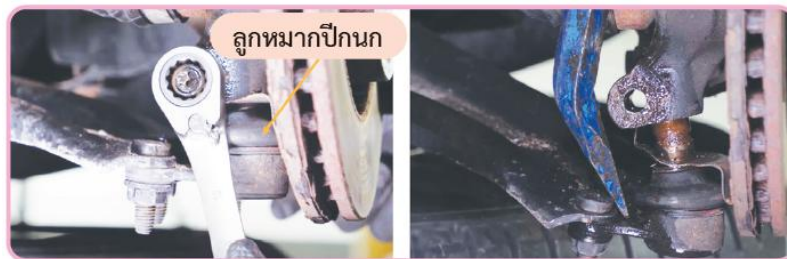
รูปที่ 12.9 ถอดลูกหมากปีกนก
