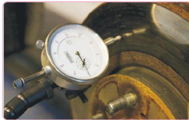
รูปที่ 4.72 วัดความบิดเบี้ยวของจานเบรก
