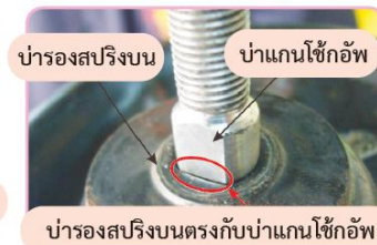
รูปที่ 8.21 บารองสปริงบนตรงกับบ่าแกนโช้กอ๊พ
