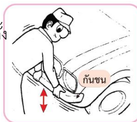
รูปที่ 9.13 ขย่มรถยนต์เพื่อตรวจสอบการทำงานโช้กอัพ
