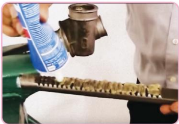
รูปที่ 7.28 หล่อลื่นจาระบีเฟืองสะพาน
