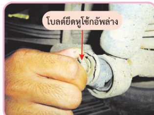
รูปที่ 9.19 ถอดโบลต์ยึดหูโซ่ข้อพับด้านล่างออก
