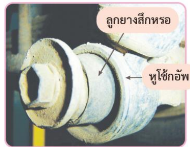
รูปที่ 9.16 ลูกยางโซ่ข้อพับสึกหรอ
