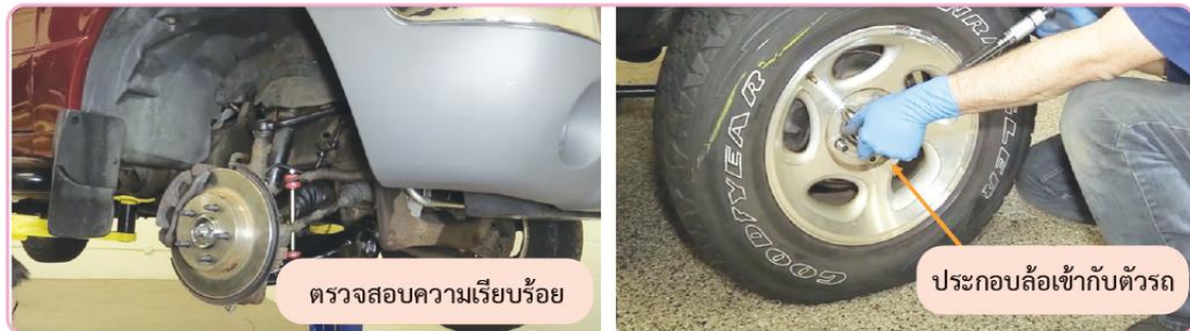
รูปที่ 10.12 ตรวจสอบและประกอบล้อ
