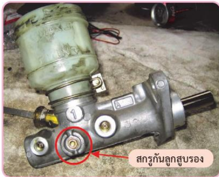
รูปที่ 4.46 ถอดสกรูกันลูกสูบรอง
