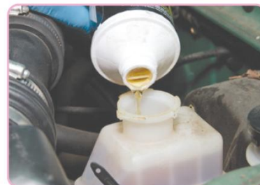
รูปที่ 4.59 เติมน้ำมันเบรกในกระปุกเก็บน้ำมันเบรก
