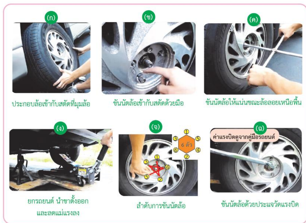
รูปที่ 3.29 ขั้นตอนการประกอบล้อรถยนต์
