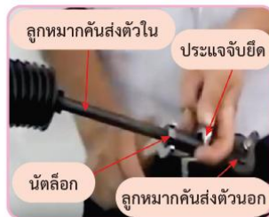
รูปที่ 7.8 คลายนัตล้อลูกหมากคันส่ง
