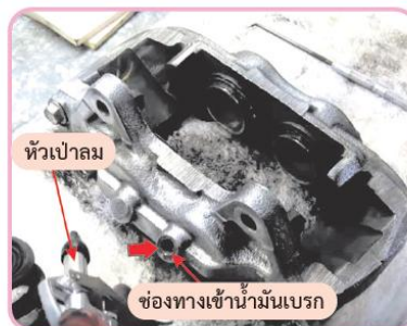
รูปที่ 4.82 ช่องทางเข้าน้ำมันเบรก ที่คาลิเปอร์สำหรับใช้ลมอัด
