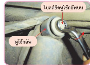
รูปที่ 9.17 คลายโบลต์ยึดหูโซ่ข้อพับด้านบน
