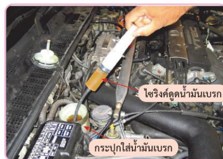
รูปที่ 4.43 ดูดน้ำมันเบรกออกจากกระจุก
