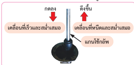
รูปที่ 8.14 ตรวจสอบการทำงานของไข่อัพจังหวะเดียว
