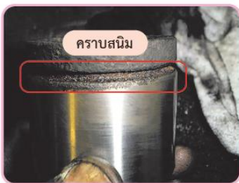
รูปที่ 4.91 ครอบสนิมที่ลูกสูบ
