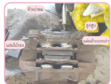
รูปที่ 4.83 ใช้ลมอัด เพื่อถอดลูกสูบ
