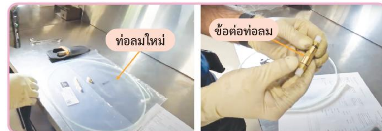
รูปที่ 14.11 ตรวจสอบท่อลมใหม่
