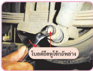
รูปที่ 9.18 คลายโบลต์ยึดหูโซ่ข้อพับด้านล่าง
