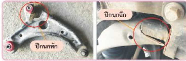
รูปที่ 12.12 ตรวจสอบปีกนก
