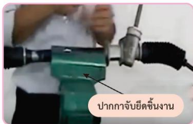
รูปที่ 7.7 จับยึดกระปุกพวงมาลัยด้วยปากกา
