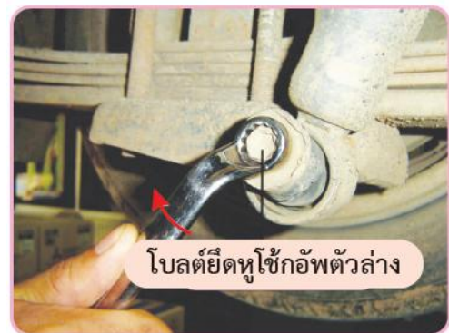
รูปที่ 9.28 ขันโบลต์ยึดโช้กอัพตัวล่าง
