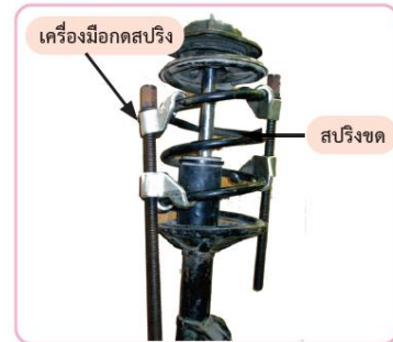
รูปที่ 8.10 ติดตั้งเครื่องมือถอดสปริง
