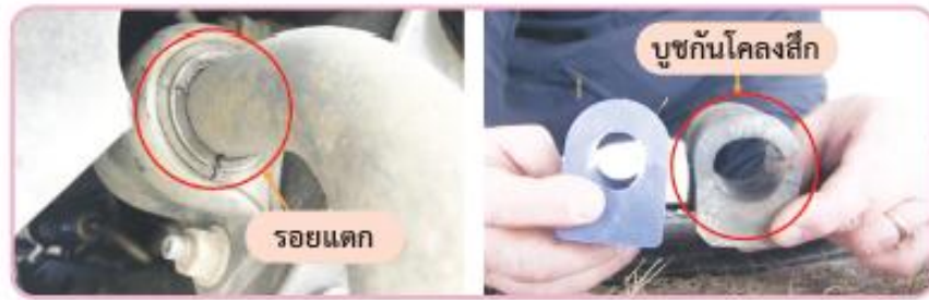
รูปที่ 13.18 ตรวจสอบบุชกันโคลง
