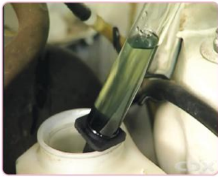
รูปที่ 4.62 ดูดน้ำมันเบรกออกจากกระปุกน้ำมันเบรก
