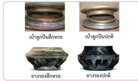
รูปที่ 8.17 ตรวจสอบลูกปืนที่เข้าร่องโช้กอ๊พและยางรองสปริง
