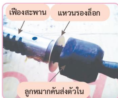
รูปที่ 7.36 ประกอบแหวนรองล็อก และลูกหมากคันส่งตัวใน
