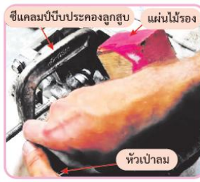
รูปที่ 4.86 ถอดลูกสูบที่เหลือ
