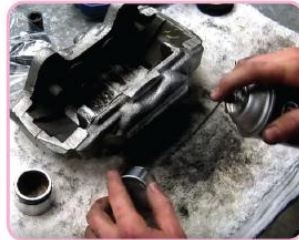
รูปที่ 4.92 ทำความสะอาดลูกสูบด้วยน้ำยา
