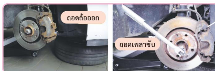
รูปที่ 12.7 ถอดล้อและถอดเพลลาขับ
