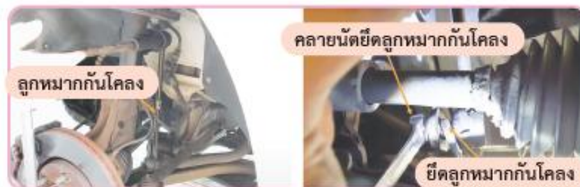
รูปที่ 13.15 ยึดลูกหมากกันโคลง
