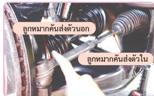
รูปที่ 7.6 สังเกตความหลวมลูกหมากคันส่งตัวในและลูกหมากตัวนอก
