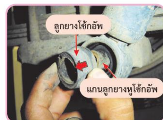
รูปที่ 9.20 ถอดลูกยางโซ่ข้อพับ
