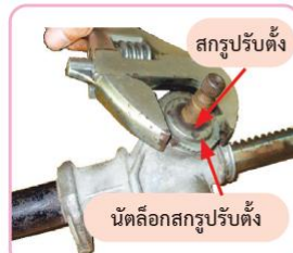
รูปที่ 7.19 คลายนัตล็อก สกรูปรับตั้งลูกปืนเฟือง เพลลาขับ
