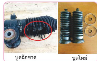
รูปที่ 7.25 สภาพบุตฉีกขาดและบุตใหม่
