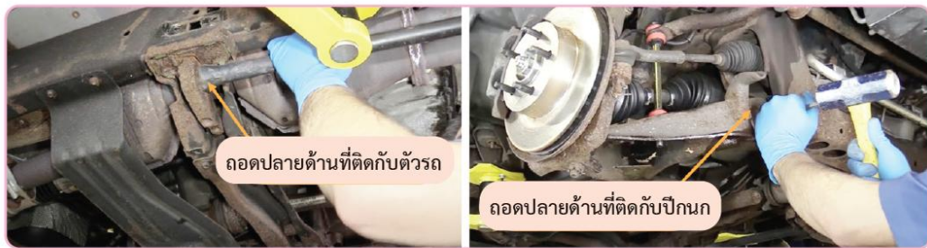
รูปที่ 10.9 ถอดทอร์ชันบาร์ออกจากรถ
