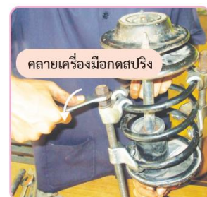
รูปที่ 8.24 คลายเครื่องมือกดสปริง
