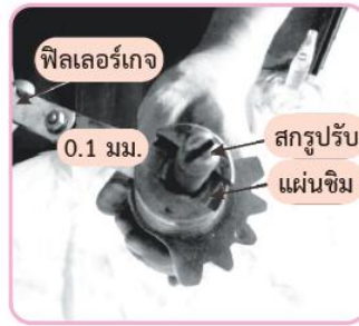
รูปที่ 6.24 ตำแหน่งการ ปรับแต่งสกรูและแผ่นซีม
