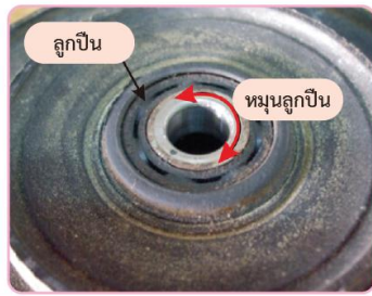
รูปที่ 8.16 ตรวจสอบลูกปืนที่เข้าร่องโช้กอ๊พ
