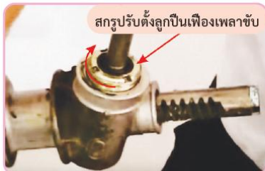
รูปที่ 7.31 ประกอบสกรูปรับตั้งลูกปืนเฟืองเพลาชับ
