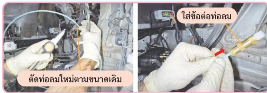
รูปที่ 14.13 ตัดท่อลมใหม่ต่อเข้าข้อต่อ
