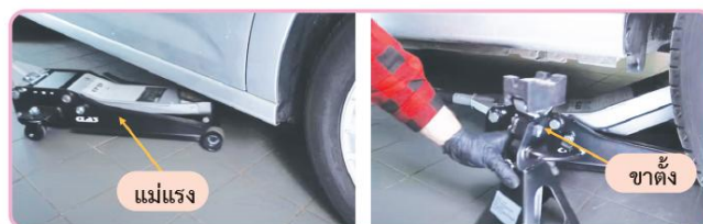
รูปที่ 12.6 ขึ้นแม่แรงรองขาตั้ง
