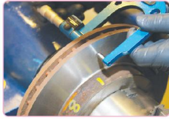
รูปที่ 4.70 วัดความหนาจานเบรกด้วยไมโครมิเตอร์
