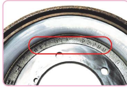
รูปที่ 4.114 ค่าสึกหรอสูงสุดของดรัมเบรก
