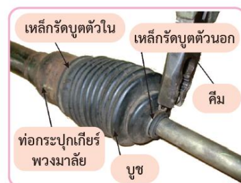
รูปที่ 7.13 ถอดเหล็กรัดบูตกันฝุ่น
