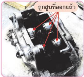
รูปที่ 4.87 ลูกสูบที่ซีแลมป์ถอดออกมาแล้ว
