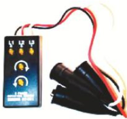
รูปที่ 9.5 ตัวอย่างเครื่องวัดลำดับเฟสแบบอาศัยหลอดไฟ
