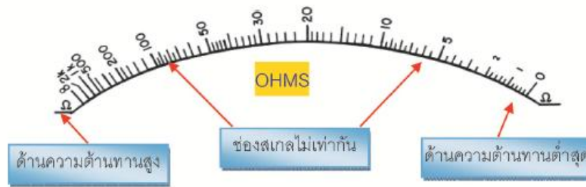
รูปที่ 4.4 สเกลหน้าปัดของโอห์มมิเตอร์
