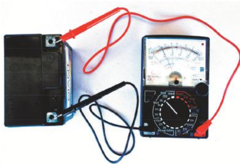
รูปที่ 2.5 ตัวอย่างการวัดแรงดันไฟฟ้าของแบตเตอรี่ด้วยมัลติมิเตอร์
