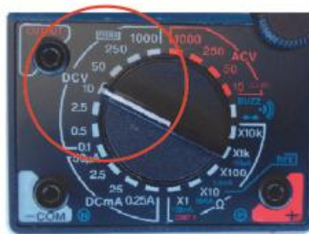
รูปที่ 2.4 ย่านวัด DCV ของมัลติมิเตอร์ยี่ห้อ YX-360TRE-B
