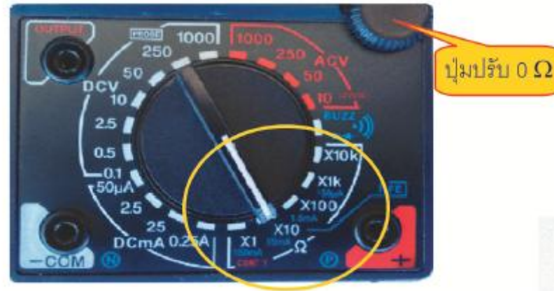
รูปที่ 2.12 ย่านวัดโอห์มของมัลติมิเตอร์ยี่ห้อ YX-360TRE-B
