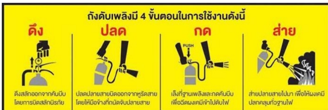
ภาพที่ 7 การตรวจเช็คและการทำงานถังดับเพลิง
