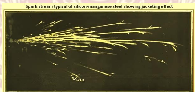
รูปที่ 4 กระแสประกายไฟที่เป็นลักษณะเฉพาะของเหล็กซิลิกอน-แมงกานีส
