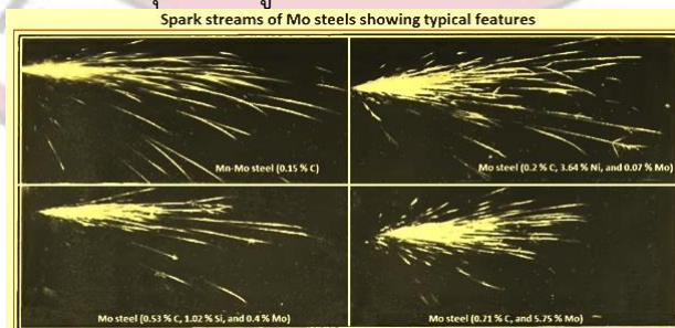
รูปที่ 13 กระแสประกายไฟของเหล็ก Mo แสดงลักษณะทั่วไป
