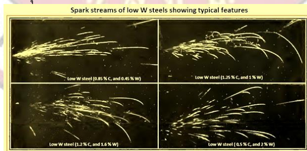
รูปที่ 14 กระแสประกายไฟของเหล็ก W ต่ำที่แสดงคุณสมบัติทั่วไป
