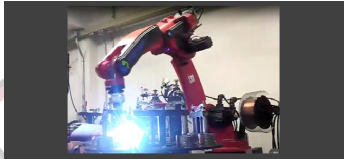
รูปที่ 5-10 แสดงลักษณะแขนกลหุ่นยนต์อุตสาหกรรมงานเชื่อม
