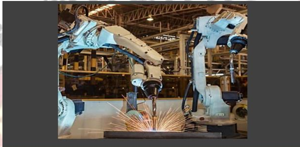
รูปที่ 5-1 แสดงลักษณะแขนกลหุ่นยนต์ในอุตสาหกรรมงานเชื่อม
