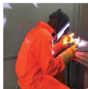
รูปที่ 2.10 แสดงการสวมใส่ชุดปฏิบัติงานเชื่อมโลหะ
