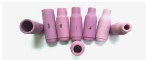
รูปที่ 1.8 แสดงลักษณะหัวฉีดที่ใช้ในงานเชื่อมอาร์กทั้งสแตนเลสและสแตนเลส
