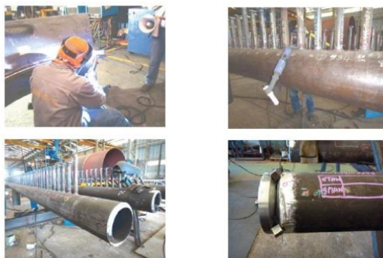
รูปที่ 3.15 แสดงลักษณะงานเชื่อมเหล็กกล้าคาร์บอนด้วยการเชื่อมอาร์กทั้งสแตนเลสสตีล
