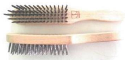
รูปที่ 2.5 แสดงลักษณะแปรงลวดขัดชิ้นงานเชื่อม
