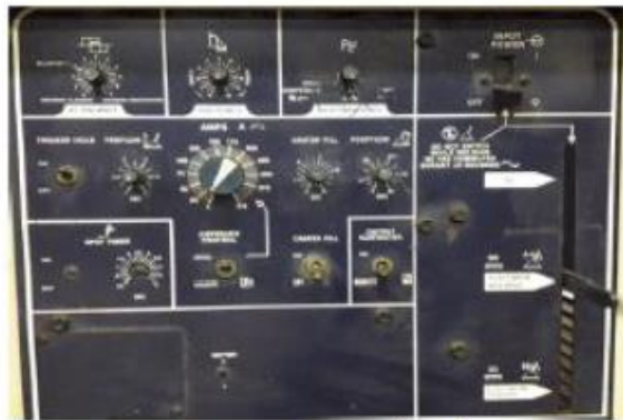
รูปที่ 5.1 แสดงแผงปรับพารามิเตอร์ของเครื่องเชื่อมอาร์กทั้งสแตนเลสสตีลและเหล็ก
