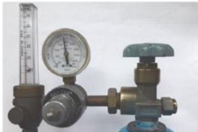
รูปที่ 5.2 แสดงชุดควบคุมการไหลของแก๊สของเครื่องเชื่อมอาร์กทั้งสแตนเลสสตีลและเหล็ก
