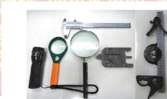
รูปที่ 4.1 แสดงลักษณะอุปกรณ์การตรวจสอบงานเชื่อมด้วยการพินิจ
