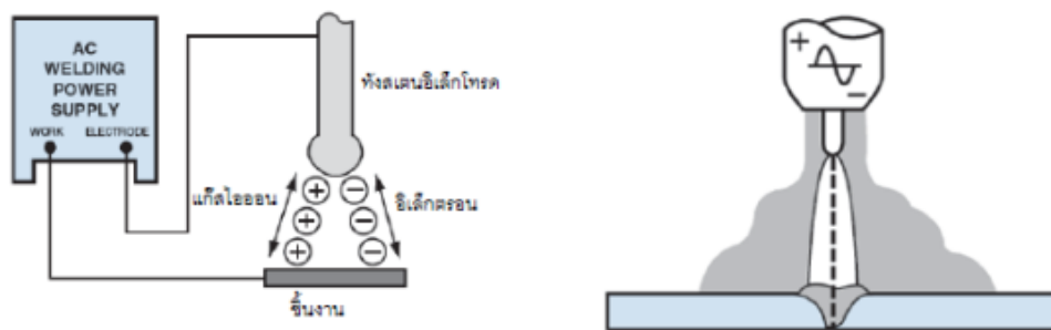
รูปที่ 1.13 แสดงระบบวงจรของกระแสไฟเชื่อมชนิดกระแสสลับความถี่สูง (ACHF)
