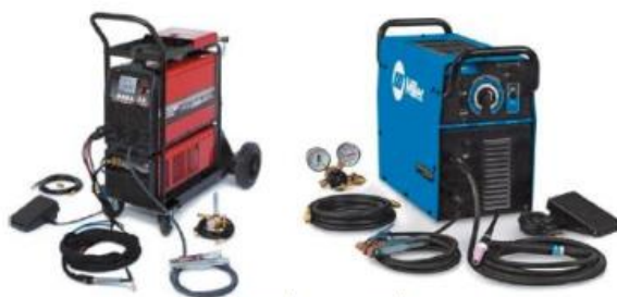
รูปที่ 1.3 แสดงลักษณะเครื่องเชื่อมงานเชื่อมอาร์กทังสเตนแก๊สคลุม
