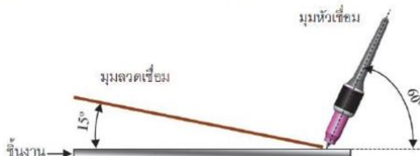
รูปที่ 3.10 แสดงมุมหัวเชื่อมและลวดเชื่อมเติมการเชื่อมท่าราบ
