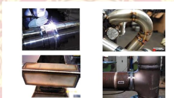
รูปที่ 3.16 แสดงลักษณะงานเชื่อมเหล็กกล้าไร้สนิมด้วยการเชื่อมอาร์กทั้งสแตนเลสคัลม
