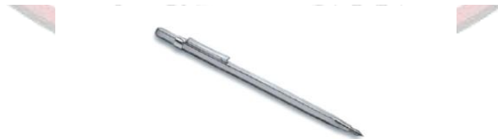
รูปที่ 2.8 แสดงลักษณะเหล็กขีดสำหรับร่างแบบชิ้นงานเชื่อม
