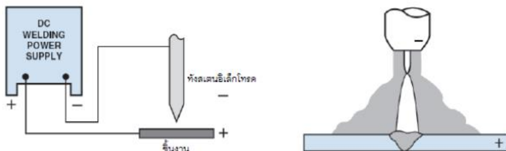
รูปที่ 1.14 แสดงระบบวงจรของกระแสไฟเชื่อมชนิดกระแสตรงขั้วตรง (DCEN)
