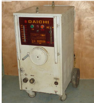
รูปที่ 5.16 แสดงรูปเครื่องเชื่อมแบบหม้อแปลงต่อกะดุมออกมาจากขดลวดทุติยภูมิ
