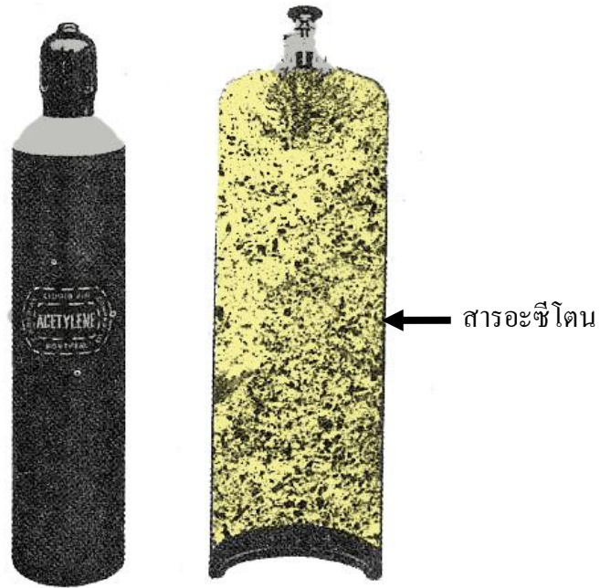
รูปที่ 1.29 แสดงลักษณะภายในของถังแก๊สอะเซทิลีน
