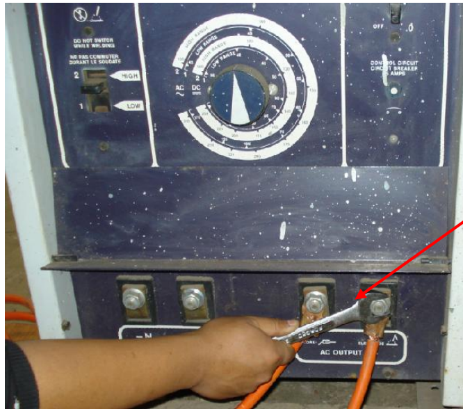
รูปที่ 5.10 แสดงการขันอุปกรณ์ขั้วต่อสายเชื่อมให้แน่นเพื่อป้องกันการอาร์กจนขั้วละลาย
