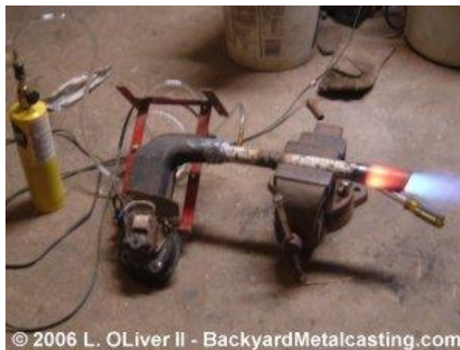
รูปที่ 3.15 แสดงเปลวแก๊ส MAPP กับออกซิเจน ในการแล่นประสาน
