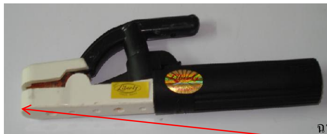
รูปที่ 5.11 แสดงหัวจับสายเชื่อมสภาพสมบูรณ์
