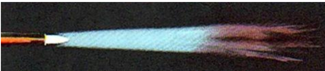
รูปที่ 1.48 แสดงเปลวออกซิไดซิง (Oxidizing Flame) ที่มา : ALTHOUSE,TURNQUIST,BOWDITCH. 1980 : 29
