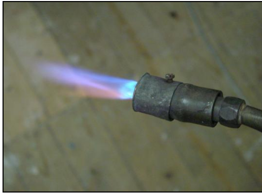
รูปที่ 3.16 แสดงเปลวแก๊สโพรเพน กับออกซิเจน ในการเล่นประสาน ที่มา : content.answers.com
