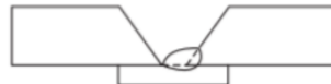
ลักษณะการวางตำแหน่งของรอยเชื่อมซ้อนไม่เหมาะสม
