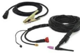
รูปที่ 1.6 แสดงลักษณะหัวเชื่อมและสายเชื่อมอาร์กทั้งสแตนเลสสตีลและอลูมิเนียม
