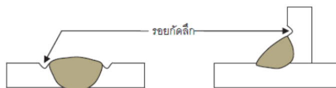
รูปที่ 4.24 แสดงลักษณะจุดบกพร่องชนิดรอยกัดลึก
