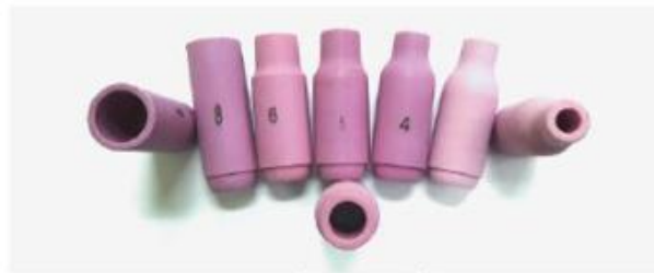
รูปที่ 1.8 แสดงลักษณะหัวฉีดที่ใช้ในงานเชื่อมอาร์กทั้งสแตนเลสและสคลุม
