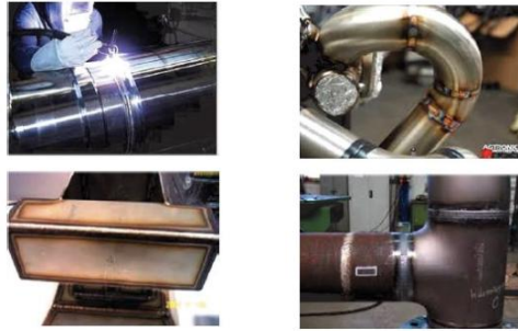
รูปที่ 3.16 แสดงลักษณะงานเชื่อมเหล็กกล้าไร้สนิมด้วยการเชื่อมอาร์กทั้งสแตนเลสคลุม
