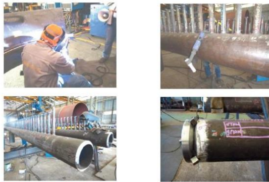
รูปที่ 3.15 แสดงลักษณะงานเชื่อมเหล็กกล้าคาร์บอนด้วยการเชื่อมอาร์กทั้งสแตนเลสคลุม
