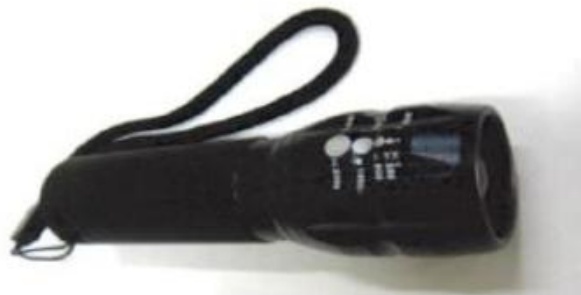
รูปที่ 2.14 แสดงลักษณะไฟฉายสำหรับใช้ตรวจสอบงานเชื่อม
