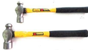
รูปที่ 2.3 แสดงลักษณะค้อนใช้ในการตอกแต่งชิ้นงานเชื่อมอาร์กทั้งสแตนเลสและสแตนเลสคลุม
