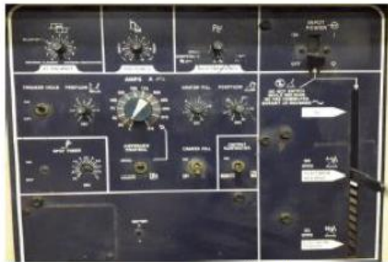
รูปที่ 5.1 แสดงแผงปรับพารามิเตอร์ของเครื่องเชื่อมอาร์กทั้งสแตนเลสคลุม
