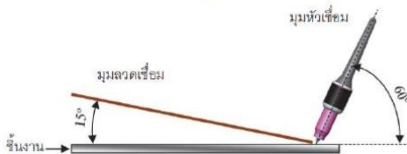
รูปที่ 3.10 แสดงมุมหัวเชื่อมและลวดเชื่อมเติมการเชื่อมท่าราบ
