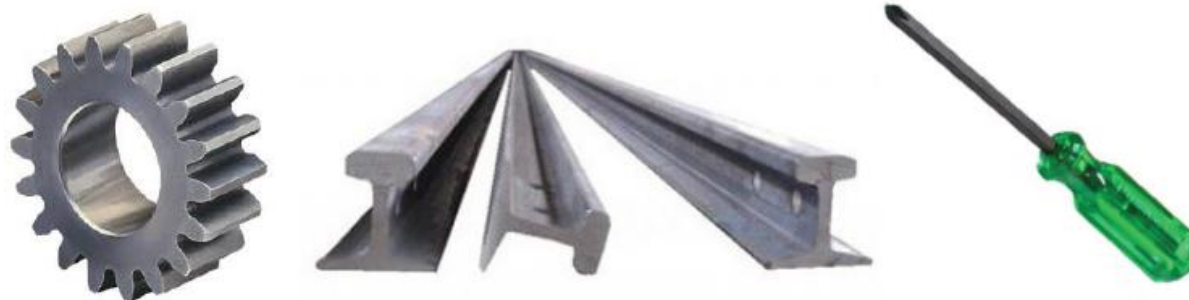
แสดงลักษณะชิ้นงานที่ทำจากเหล็กกล้าคาร์บอนปานกลาง
