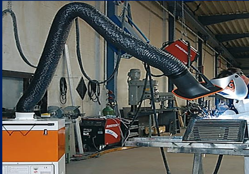
รูปที่ 7-5 แสดงลักษณะการวางเครื่องดูดควันเชื่อมที่เหมาะสม
