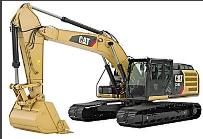
รูปที่ 5-7 แสดงลักษณะการขับเคลื่อนแกนกลด้วยไฮดรอลิกส์
