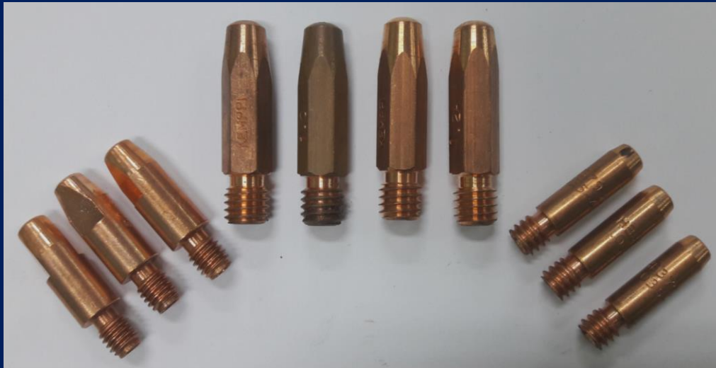
รูปที่ 1-16 แสดงลักษณะชิ้นส่วนท่อนำกระแส (Contact tube)
