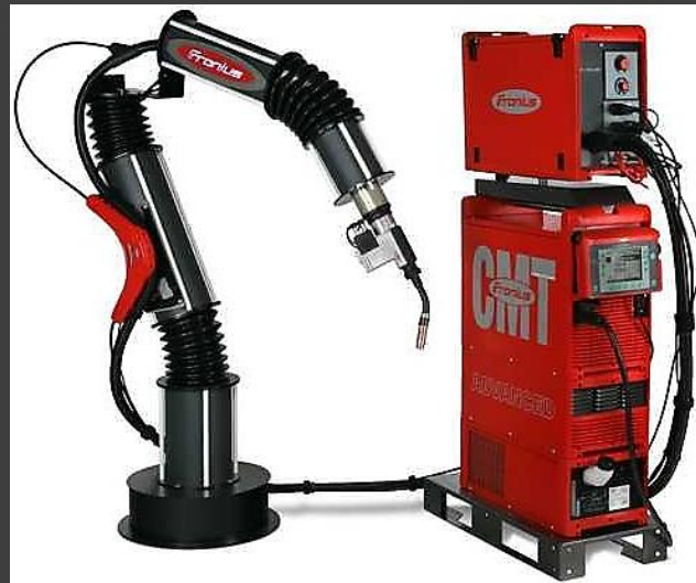
รูปที่ 5-22 แสดงลักษณะชุดเครื่องเชื่อมประกอบแขนกลหุ่นยนต์
