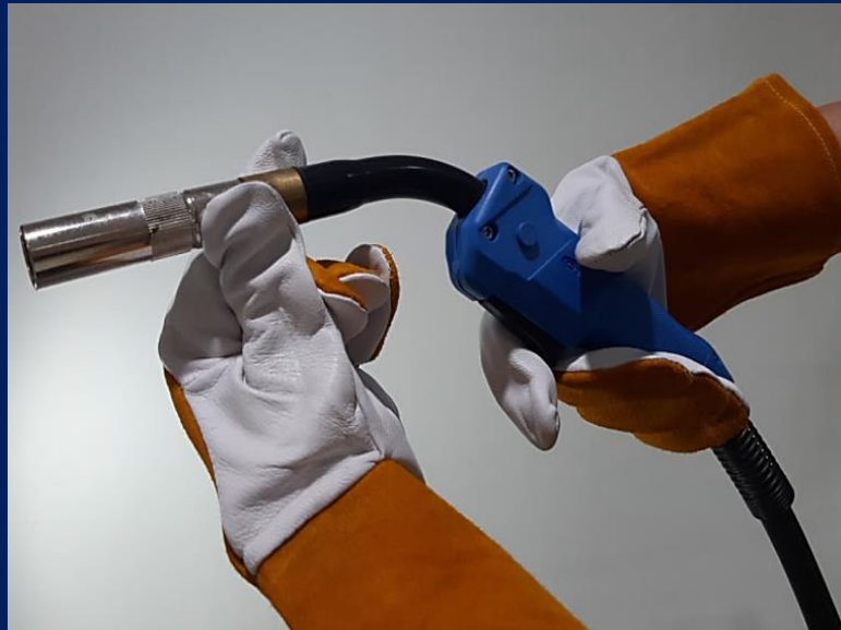
รูปที่ 7-2 แสดงลักษณะการจับหัวเชื่อมแบบสองมือ
