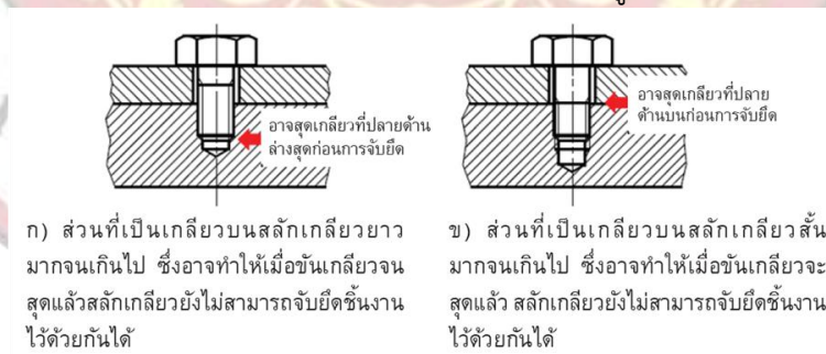
แสดงการใช้สลักเกลียวยึดชิ้นงานไม่เหมาะสม
