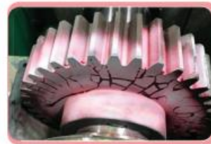
ภาพที่ 11.2 การตรวจสอบด้วยน้ำยาแม่เหล็ก
