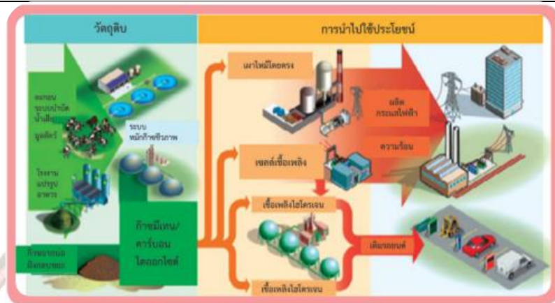
ภาพที่ 6.25 กระบวนการ และการใช้งานแก๊สชีวภาพ
