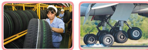
ภาพที่ 8.12 ยางล้อรถยนต์ และยางล้อเครื่องบินทำจากยางสังเคราะห์
