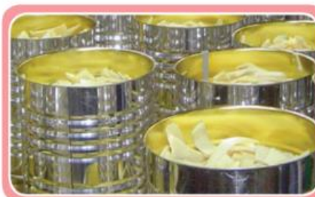
ภาพที่ 3.3 กระป๋องบรรจุอาหารทำจาก เหล็กกล้าคาร์บอนต่ำ
