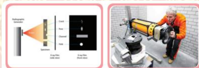
ภาพที่ 11.5 การตรวจสอบด้วยวิธีถ่ายภาพด้วยรังสี
